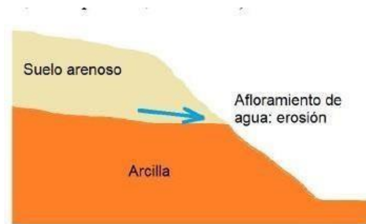
Figura 5.- Peligro de deslizamiento y erosión regresiva en estrato impermeable
