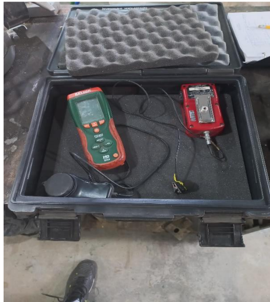
Fig. 1 : instrumentos utilizados para medir ruido e iluminación. Dosímetro a la derecha y luxómetro a la izquierda.
