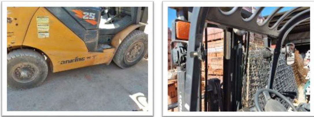
CUBIERTA TRASERA DE GIRO SIN DIBUJO Y FALTA DE ESPEJO Y AGARRE DE ASCENSO –DESCENSO
