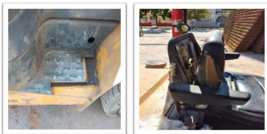
ESCALÓN DE ASCENSO Y ASIENTO SIN RELLENO DE GOMA ESPUMA
