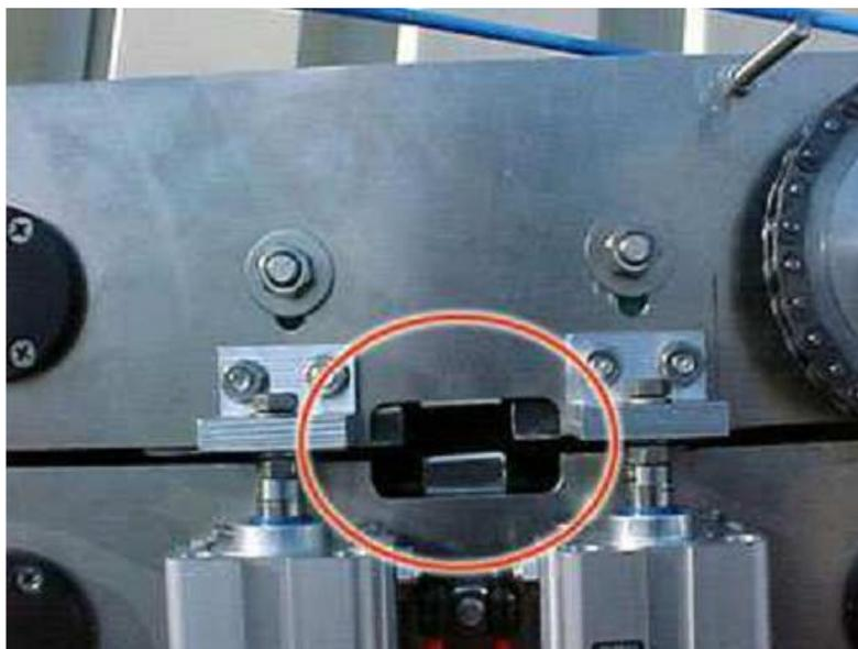
*Forma incorrecta de ensamblaje*
