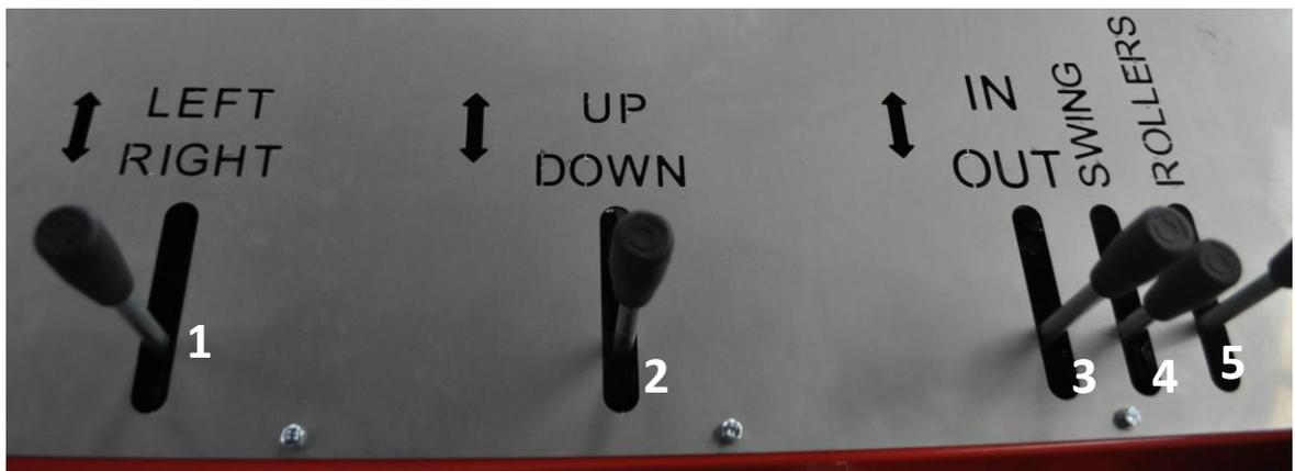
1. LEFT/RIGHT: acciona el desplazamiento del sistema a lo largo y de los rieles entre los dos extremos.
