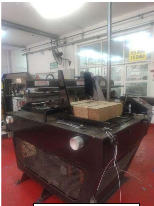
Armadora de cajas
