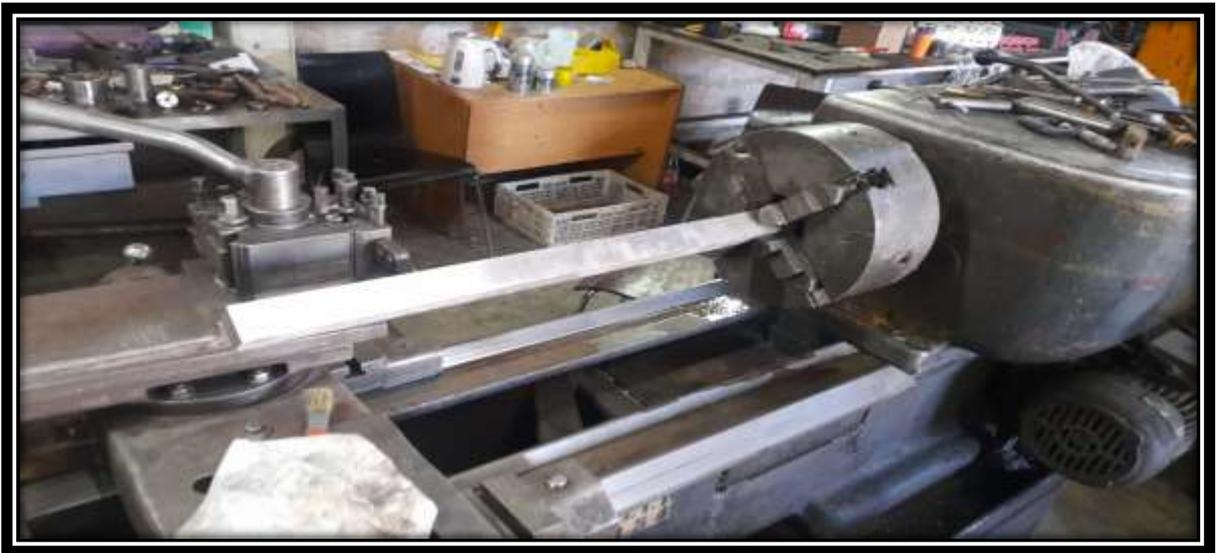
Foto n° 8 de material a mecanizar – listo de aisi 304 inoxidable
