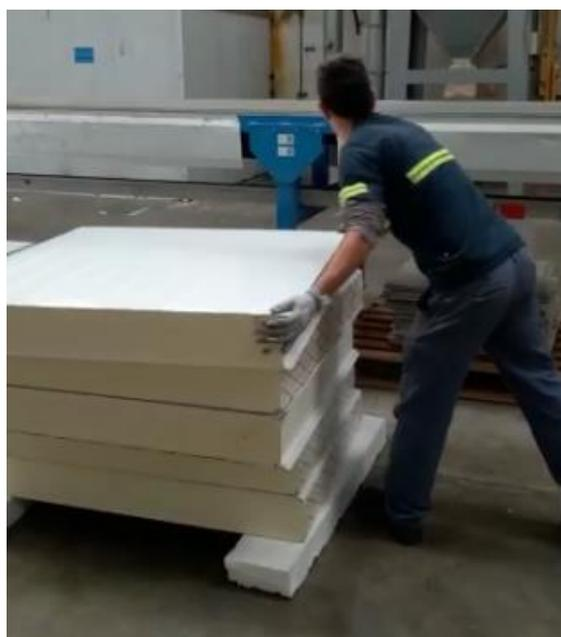
*Figura 25. Kraisellvurd N. (2023). Retiro de panel no conforme de línea de producción [Figura]. Autoría Propia*
