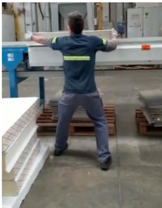
*Foto 24. Kraisellvurd N. (2023). Retiro de panel no conforme de línea de producción [Figura]. Autoría Propia*
