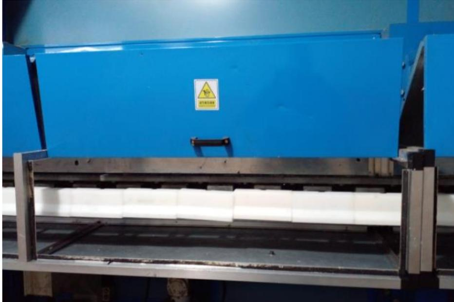
*Foto 6. Kraisellvurd N. (2023). Resguardos móviles colocados en el sector de prensa continua [Foto]. Autoría Propia*
