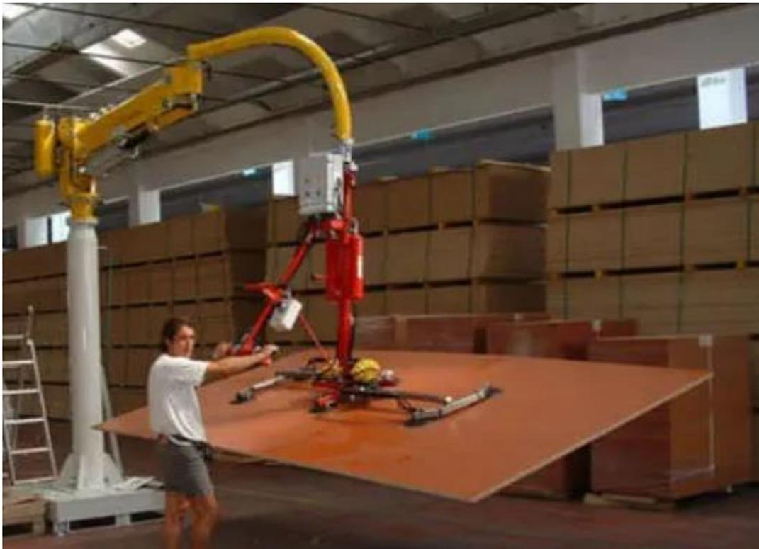
Foto 28. FAMATEC (2012). Manipulación de carga con equipo neumático [Foto]. Recuperado de <https://www.directindustry.es/prod/famatec>.
