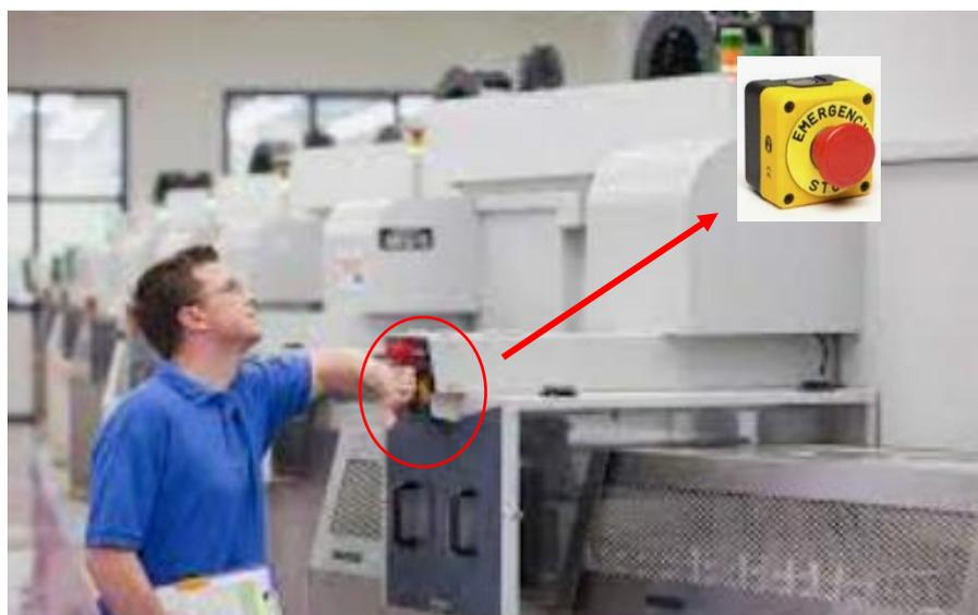
*Foto 23. ACP AUTOMATISM (2018). Prueba de funcionamiento de parada de emergencia [Figura]. Recuperado de <https://acpautomatismos.com/parada-de-emergencia-en-maquinas/>*
