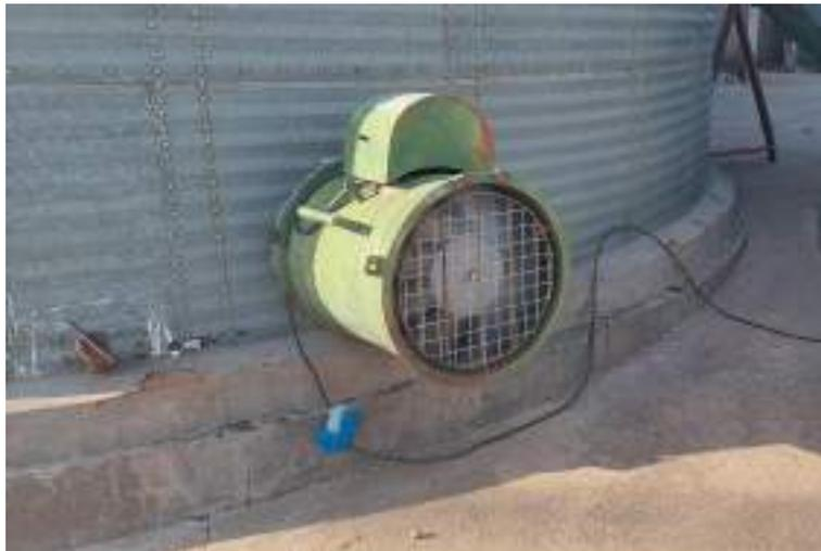
**Figura 15 – Aireadores de Silos Eléctricos**
