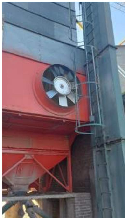
Figura 18 – Ventilador axial de Secadora
