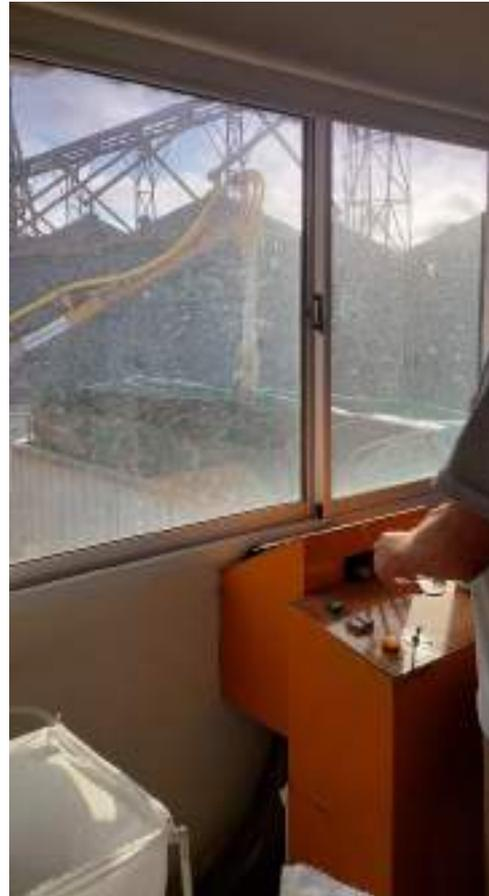
**Figura 3** – Caladora hidráulica ingresando al acoplado. **Figura 4** – Operación de calado de cereal.
