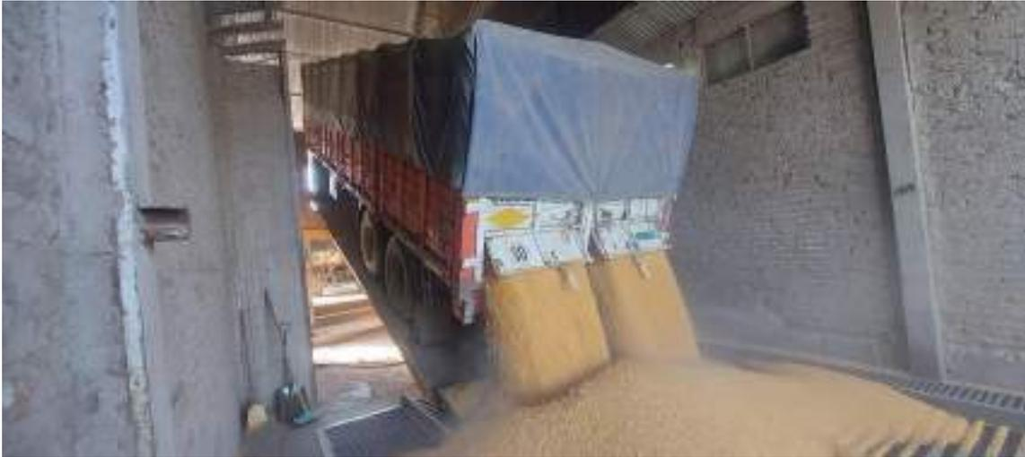
**Figura 5** – Acoplado sujeto al volquete hidráulico en descarga de maíz.
