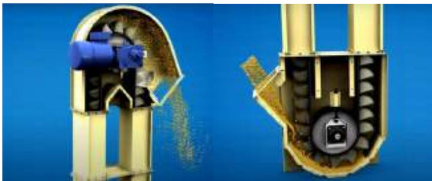
**Funcionamiento de Noria - Figura 33 – Parte Inferior**
