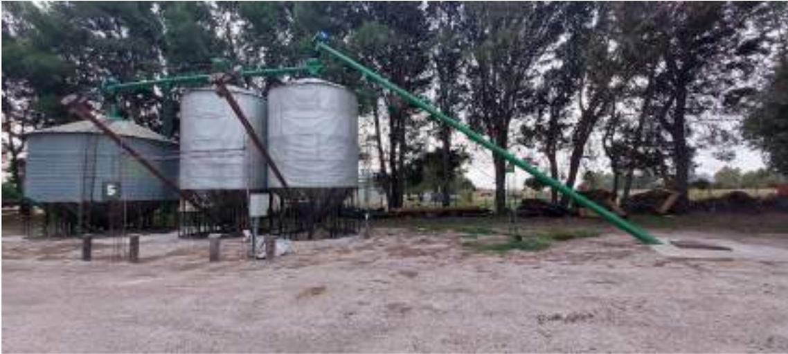
**Figura 11** – Sinfín y silos para fertilizantes y agroquímicos.
