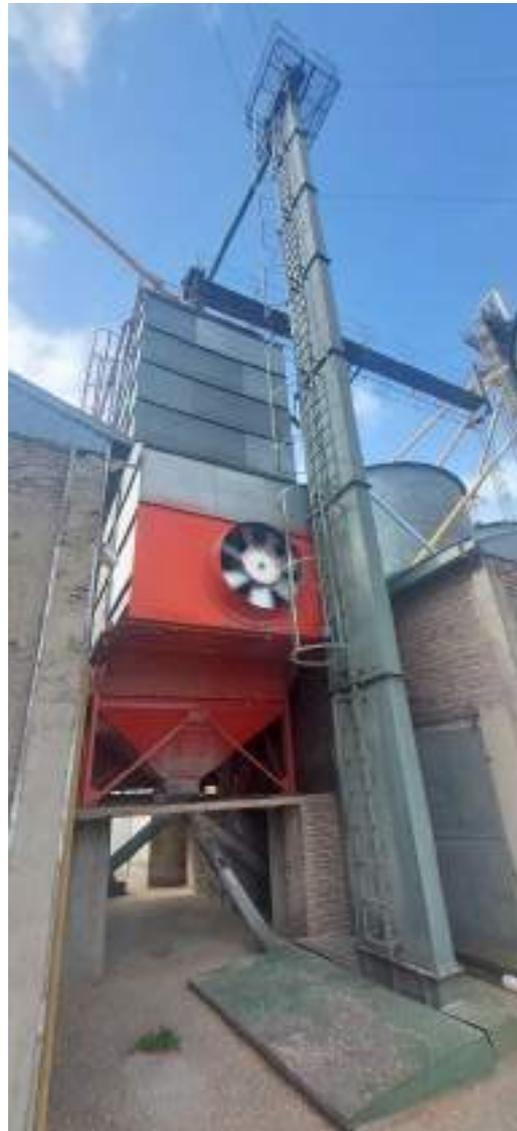
**Figura 9 y 10** – Secadora a gas de flujo continuo: quemador - salida de aire caliente y húmedo.
