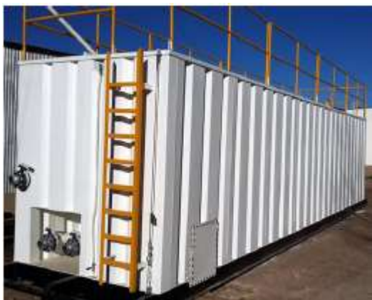
Piletas de acumulación de Petróleo y agua
