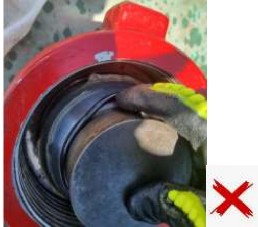
Indicios de o`ring con sobremedida, estirado o ablandado
