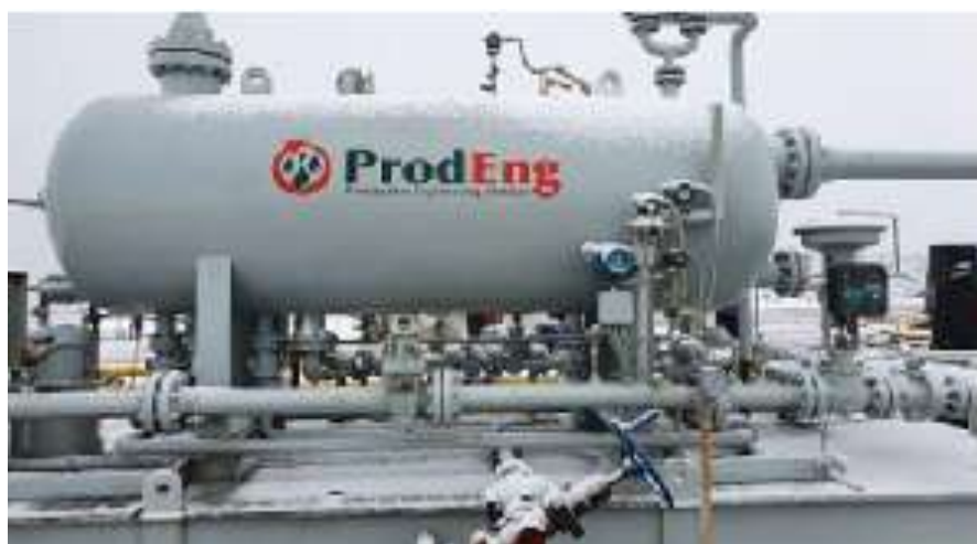
Separador horizontal trifásico
