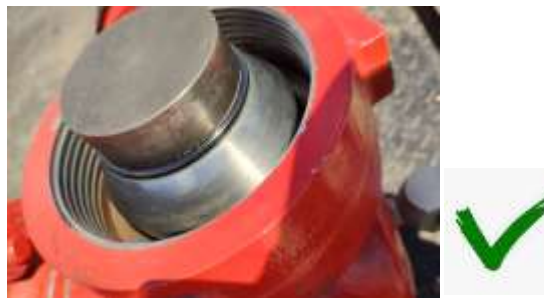
Estado y posición correcto de o`ring
