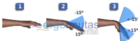
Figura 7. Medición del ángulo de la muñeca
