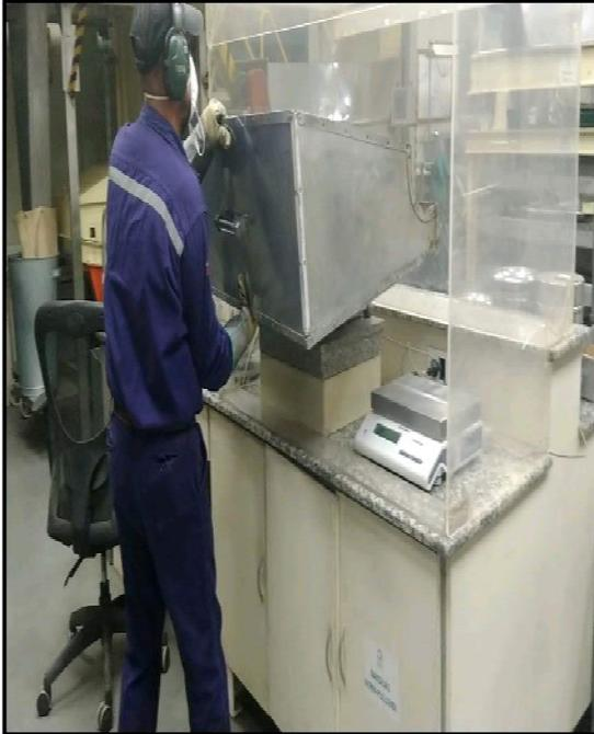
*Imagen 18 - Operario de CTS trasladando muestra al equipo Carwell Stem Tester.*
