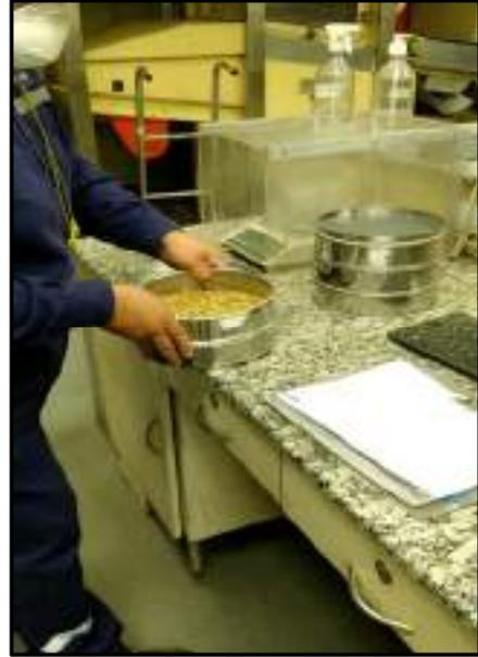
*Imagen 29 - Operario de CTS colocando muestra en plato para pesar en balanza.*
