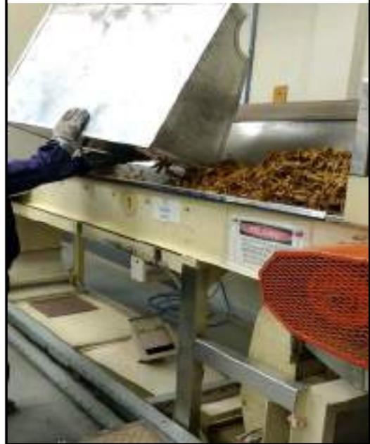
*Imagen 23 - Operario de CTS terminando de vaciar la muestra en el equipo Carwell Stem Tester*
