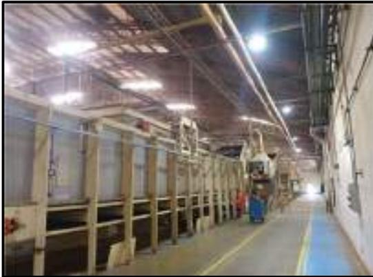
*Imagen 51 - Línea de despalillado colindante al transporte de secado ductería múltiple.*
