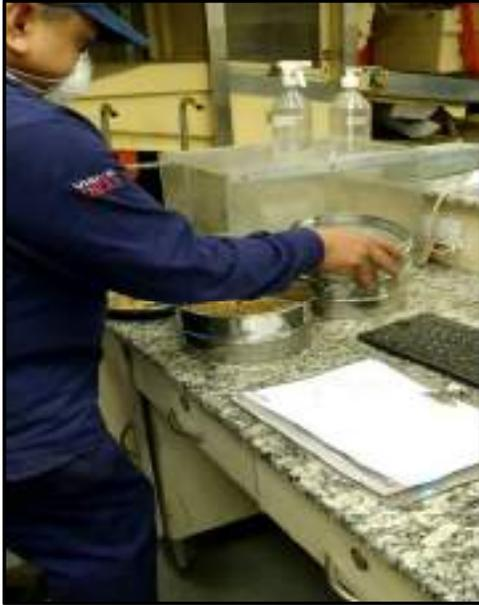
*Imagen 28 - Operario de CTS separando tamices con palo para tomar los pesos individuales de cada tamiz.*
