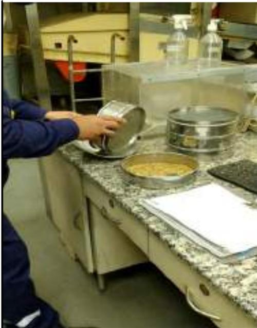
*Imagen 30 - Operario de CTS terminando el proceso de pesado y armado de tamices.*
