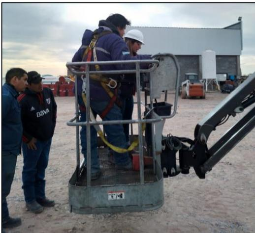
1. Inspección visual: Verificar el estado de los barandales, escalinata, cadena de protección, compartimentos de baterías y aceite, llantas, controles (terranceo y aéreo), botones, claxon e indicador de carga (debe estar completamente cargado).
