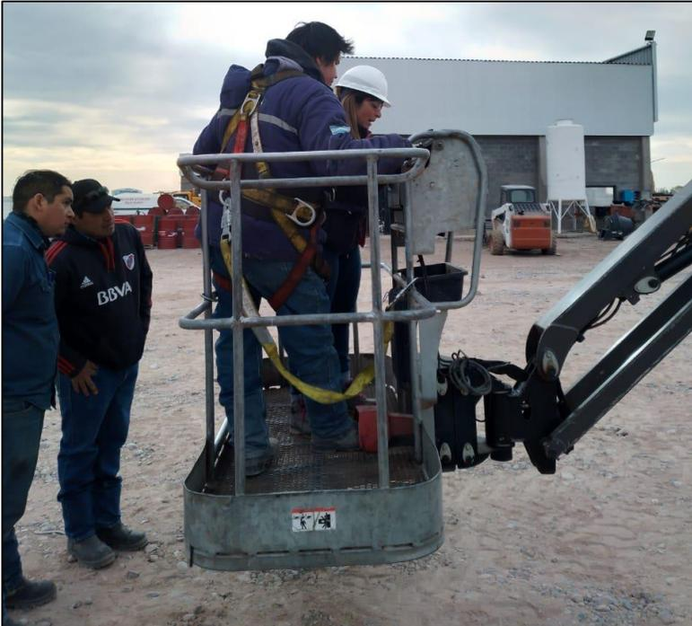
Una Plataforma Elevadora Móvil de Personal (PEMP) es un equipo de trabajo móvil utilizado para desplazar personas hasta una posición de trabajo determinada.
