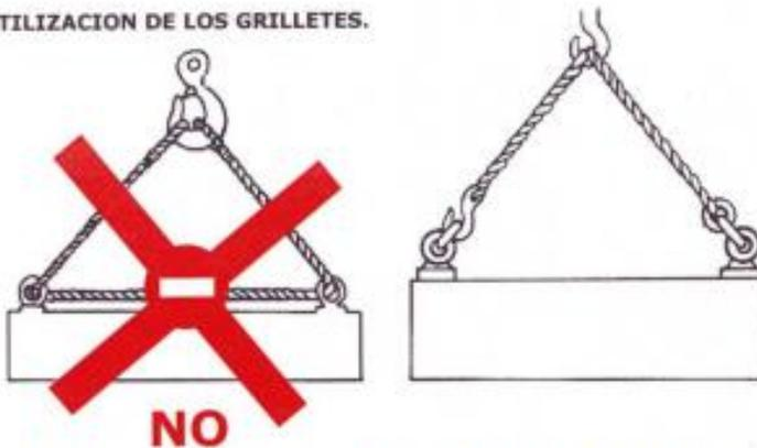
Prohibir el montaje consistiendo en pasar una eslinga simple en el interior de dos anillos antes de suspender las bandas al gancho. El esfuerzo oblicuo en cada anillo puede sobrepasar el peso de la carga y la tracción sobre la eslinga llegando a alcanzar tres veces más su peso (sin tomar en cuenta el pliegue del cable). Utilizar una eslinga con dos derivaciones (o dos eslingas sencillas) unidas por dos grilletes.
