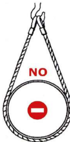
ESLINGA SIMPLE TRABAJANDO EN DOS SECTORES TIPO CANASTA
