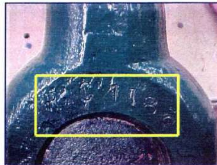
Codigo de color del 2000 y cuño identificador de la pieza
