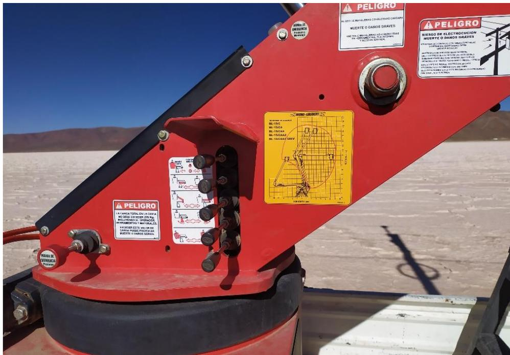
**Figura 1.3 – Comando de brazo inferior y superior**
