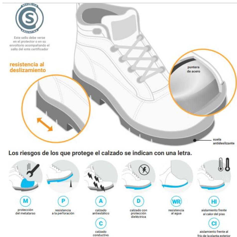
**Figura 8.2 - Calzado de seguridad**
