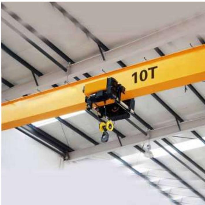
El puente grúa se utiliza para mover cargas dentro del edificio. Para realizarlo se deberá sujetar la carga al gancho o pazteca del puente grúa mediante diferentes elementos de izaje. Estos elementos son las eslingas, fajas, grilletes, etc.
