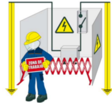
5. Proteger frente a elementos próximos en tensión, si es necesario, y señalar la zona de trabajo
