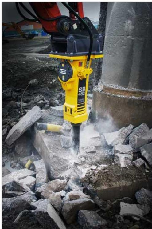
Habitualmente, la reducción de vibración en los martillos hidráulicos se realiza mediante la utilización de elementos elásticos o desacoplamientos entre el cuerpo principal y la empuñadura.
