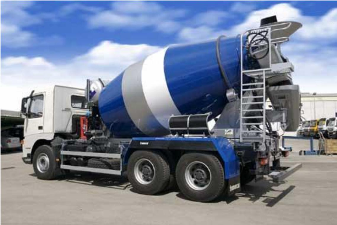
En máquinas sobre camión, como las hormigoneras, se reducen las vibraciones mediante sistemas de suspensión-amortiguadores, asientos con montajes aislantes, etc. y el ruido mediante acondicionamiento acústico de la cabina.
