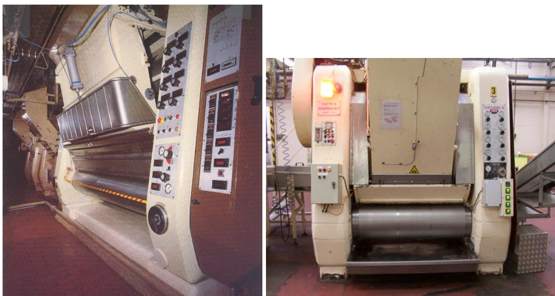
FIGURA 8 – Refinador de ocho (8) cilindros
