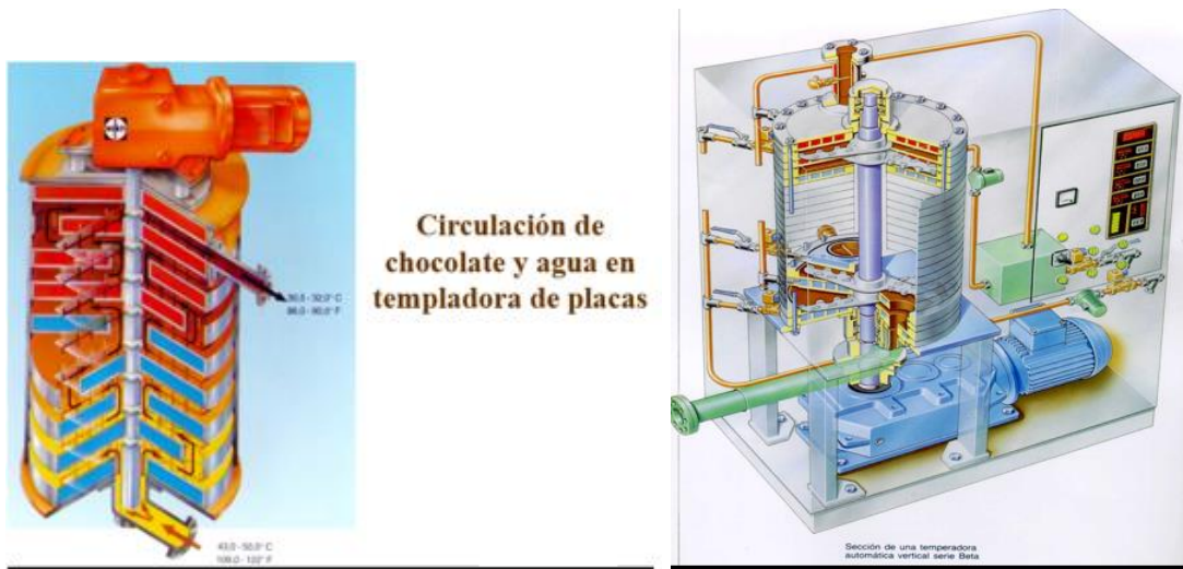
FIGURA 10 – Esquema de templadora de placas.
