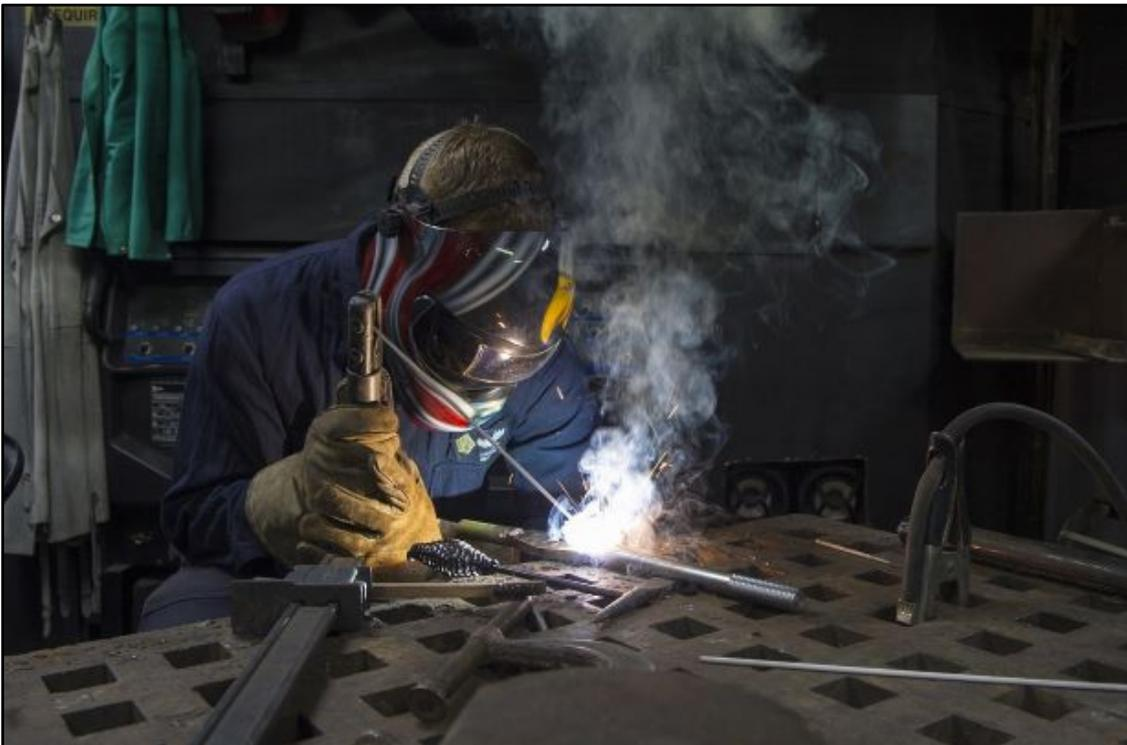
Es un proceso de unión entre metales por acción del calor, con o sin aporte de material metálico nuevo, dando continuidad a los elementos unidos. El calor funde el material de aporte uniéndolo a ambas superficies, o bien funde el propio metal de las piezas a soldar.
