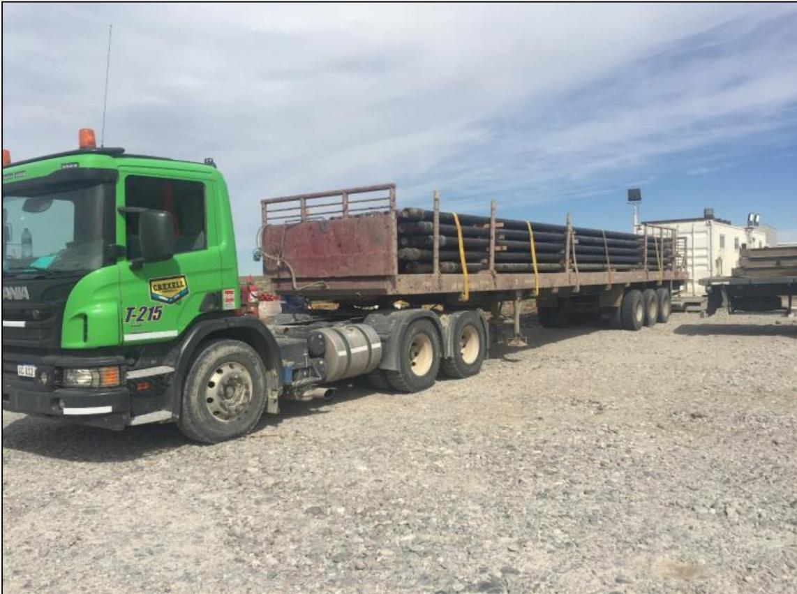
En la imagen a continuación se puede observar la sujeción de barras de sondeo mediante la utilización de fajas.
