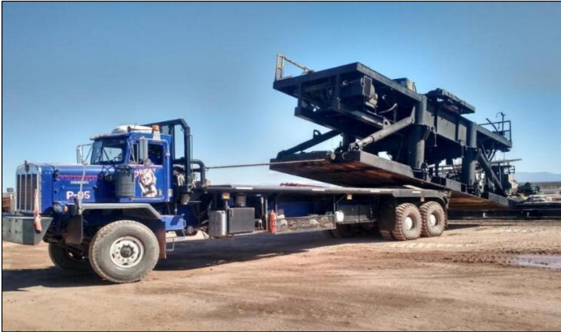
En locación de destino se produce la descarga y posicionamiento de las cargas, la misma se realiza con una secuencia ya definida y en función de la ubicación que va a ocupar cada una de ellas.
