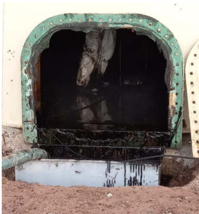
LIMPIEZA TAMIZ MOLECULAR - MATERIAL DE RELLENO SÓLIDO (EQUIPO VERTICAL)
