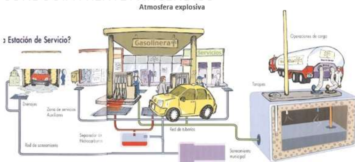
figura n° 1 esquema sistema almacenamiento subterráneo de hidrocarburo
