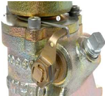
Figura n° 1 válvula de choque- detalle completa
