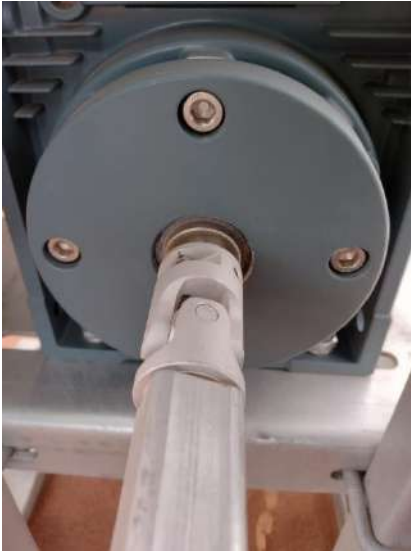
Imagen 15: Eje del motor y las barras de transmisión
