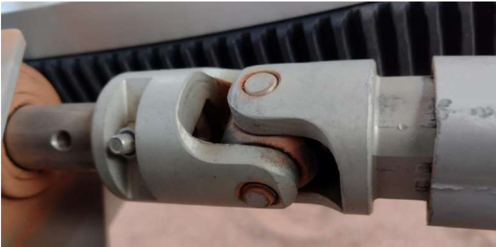
Imagen 13: Cardan en barra de transmisión
