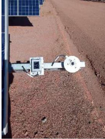
Imagen 4: Solarímetros, piranómetro y sensor PT100
