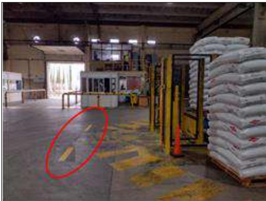
Figura nº45: Pintado de líneas de referencia para maniobra de giro del autoelevadorista, en Línea 4.
