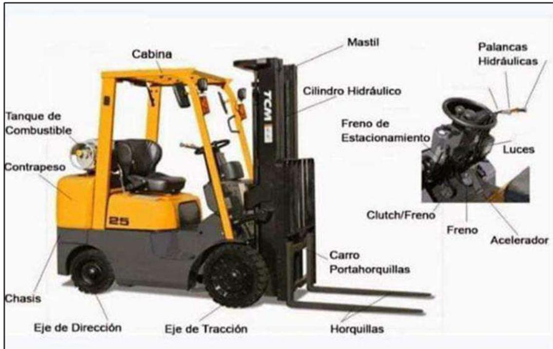
Figura 8: Partes de un autoelevador.
