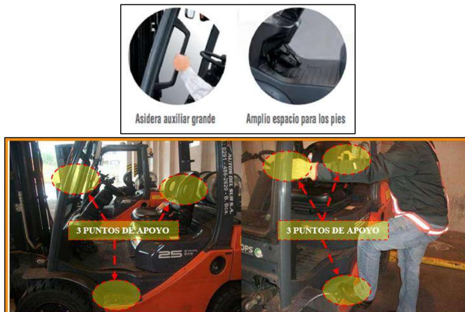
Figura 14: Asidera del equipo. Ubicación de los 3 puntos de apoyo.
