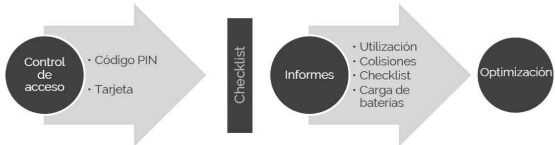
El I-Site recopila datos de la carretilla y utilización de los operarios, y los transfiere a intervalos determinados por el usuario, a un servidor central, donde luego se puede acceder a los datos, iniciando sesión en un sitio web de Internet.
