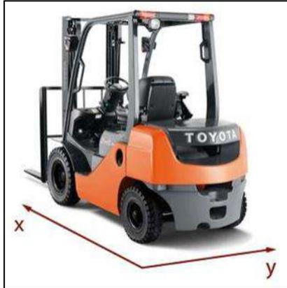
Figura 19: Ejes perpendiculares que utiliza el sistema I-SITE para medir las aceleraciones.
