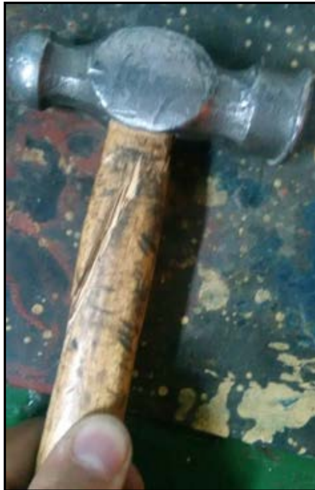
Figura N°55-Martillo con cabo fisurado
