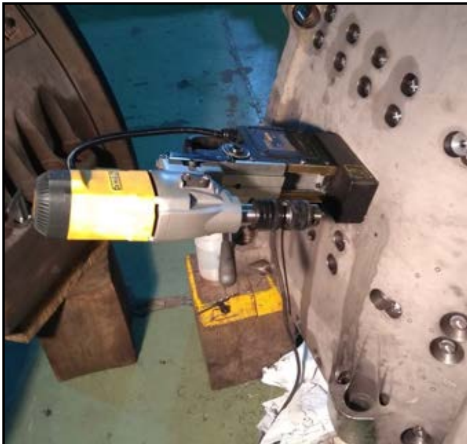
Figura 52-Uso de Taladros con base magnética
