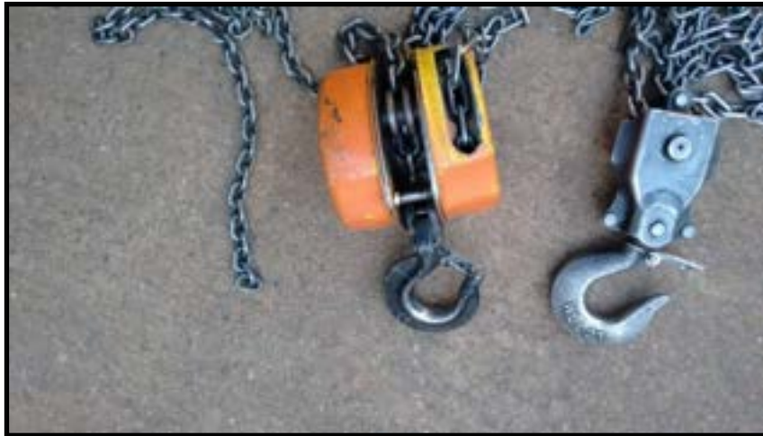
Figura N°35 - Aparejo en mal estado
