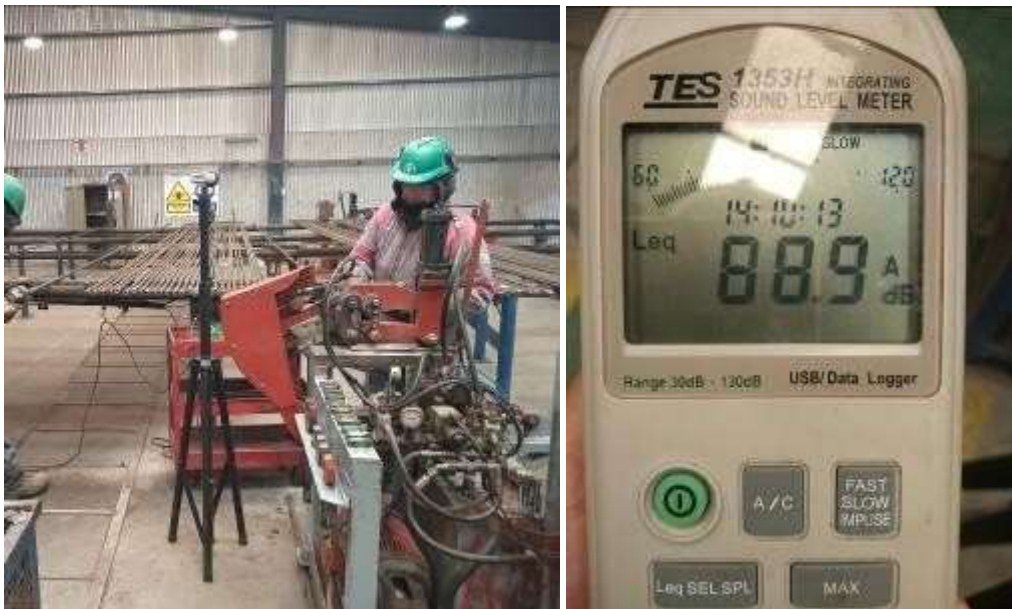
Punto de medición N°6 y 7 Sacado de Cupla y Cepillado de VB.
