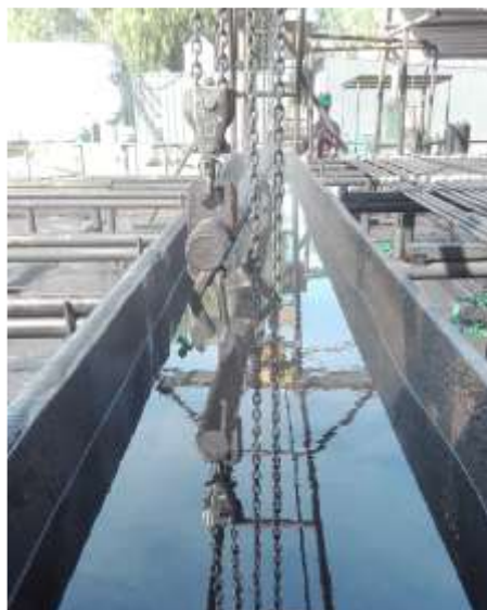
Canasto de varillas sumergido en pileta
