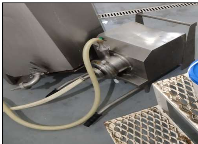
Foto del emulsionador.
