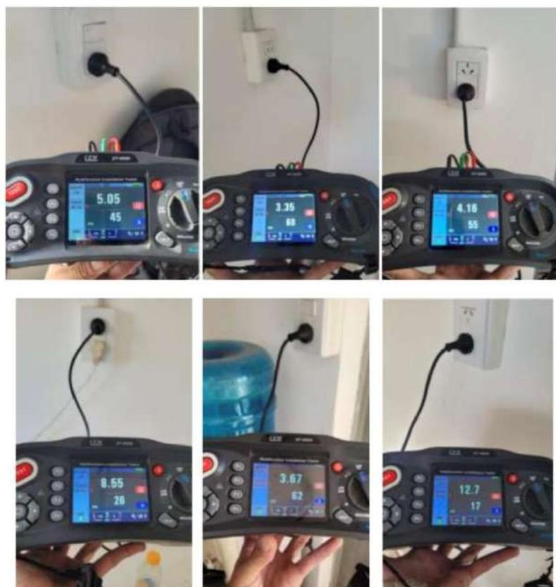
Ejemplos mediciones de continuidad y resistencia de PAT
