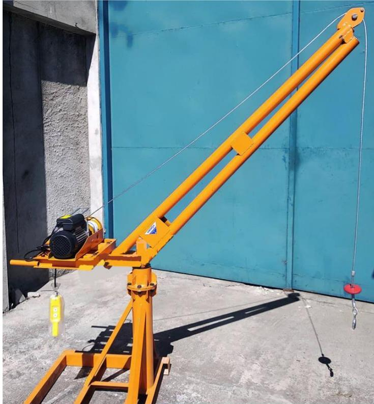
Este dispositivo consta de 1 guinche con motor de potencia 1300W, trabaja a 10m por minuto.
