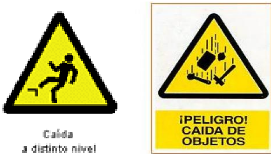
Figura 4. Señalización de Riesgo de Caída de Personas y Objetos.
