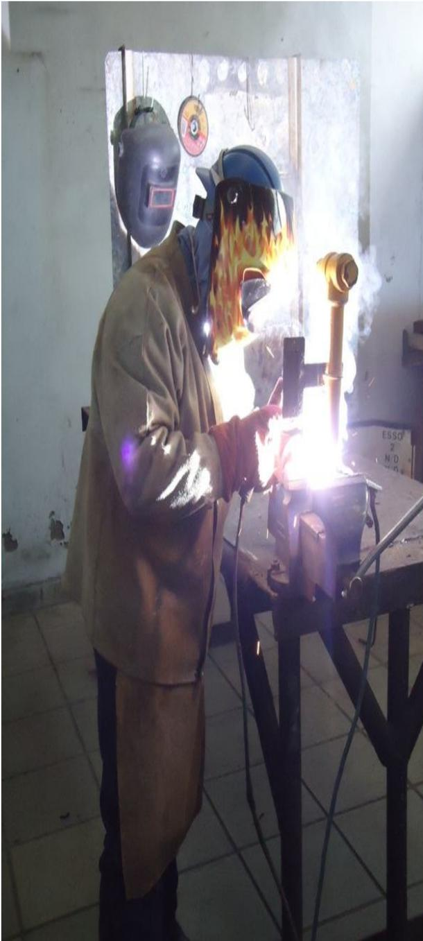
Imagen N° 3, soldando brida sobre válvula de alivio.
