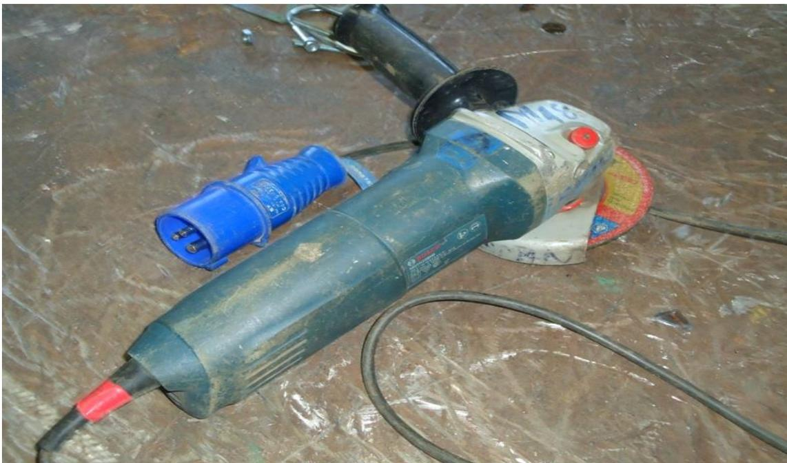
Imagen 7: amoladora utilizada en el sector de trabajo, la misma cuenta con protector de disco, ficha de conexión marca STECK, la cual tiene una mayor IP de seguridad, se encuentra con la identificación correspondiente para ser utilizada, cable en perfectas condiciones y cuenta con el sistema hombre muerto.
