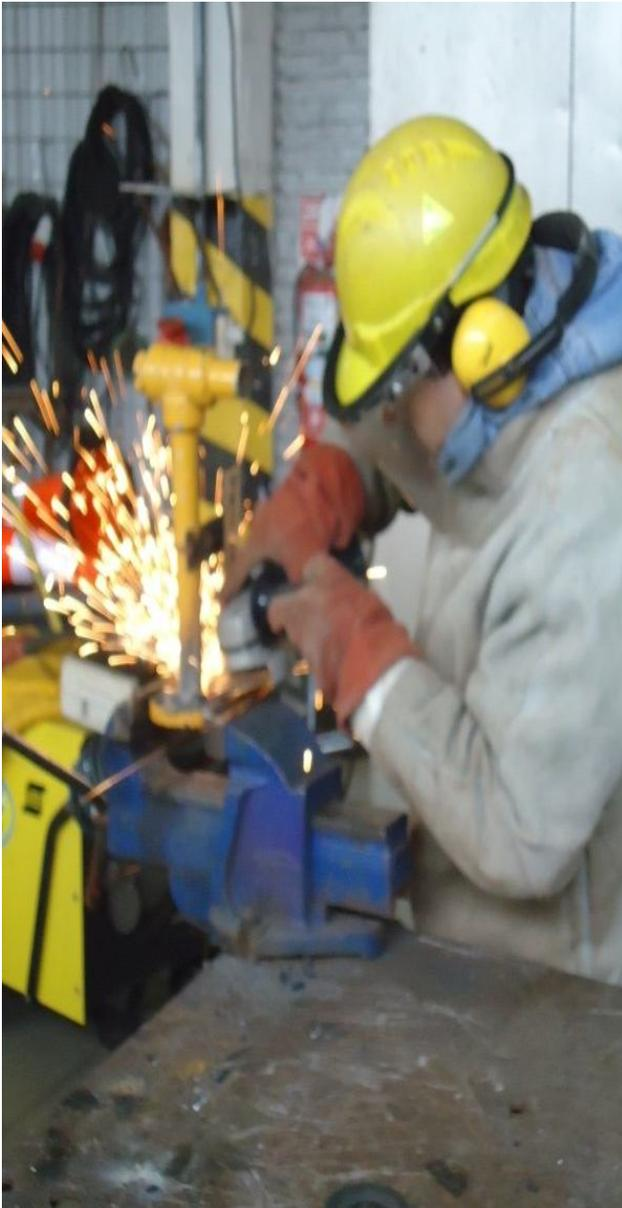
Imagen 5: pasando amoladora para retirar escoria de la soldadura.
