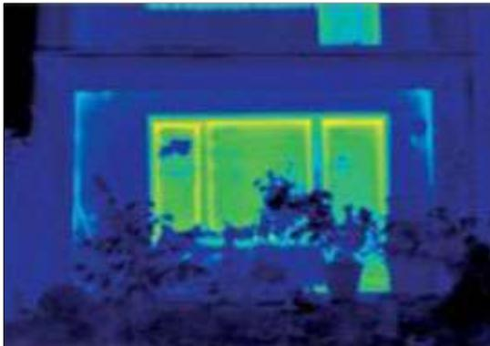
Luego de una renovación de aberturas, cambiando a PVC con doble vidriado hermético. Las aberturas ahora tienen un color verde, lo cual indica que pierden mucho menos calor, por encontrarse su parte externa menos caliente.
