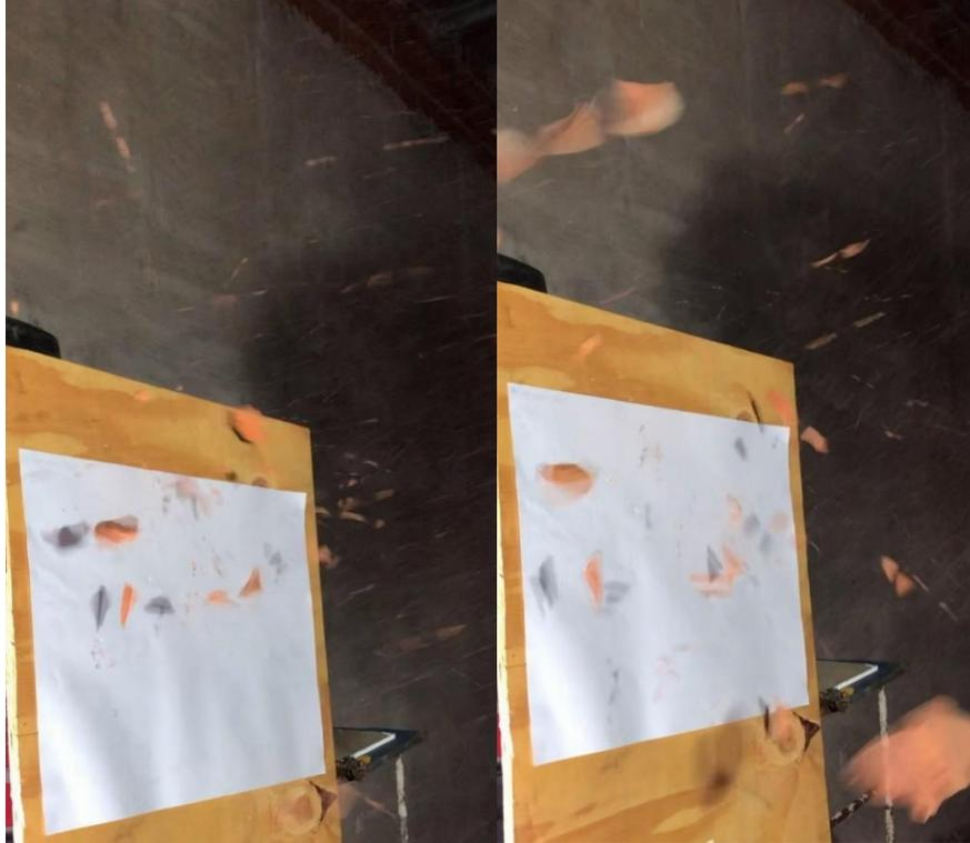
Efecto *spalling* producido por el impacto de proyectil de arma de fuego proyectando hacia la pantalla de papel grandes fragmentos de material. [Figuras 95 y 96]. Fuente: Elaboración propia.
