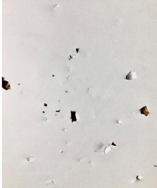
Pantalla de papel con *spalling* producido por el impacto de proyectil de arma de fuego calibre .45 ACP en madera aglomerada, a una distancia de 30 cm del telón interpuesto.
