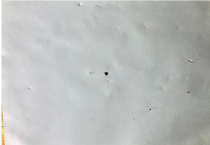
Efecto *spalling* representado en la pantalla de papel, donde se aprecian a simple vista las astillas de madera incrustadas. [Figura 55]. Fuente: Elaboración propia.
