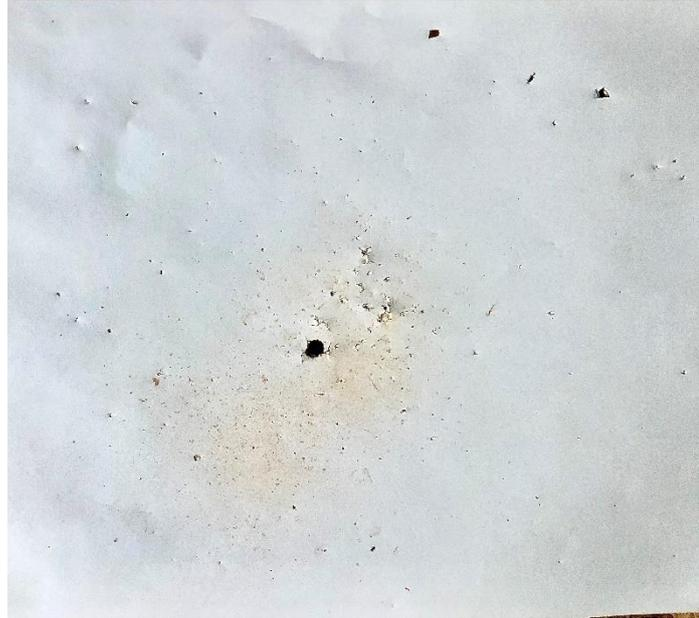
Resultado del *spalling* representado en la pantalla de papel, donde se puede apreciar fragmentos del ladrillo incrustados. [Figura 70]. Fuente: Elaboración propia.
