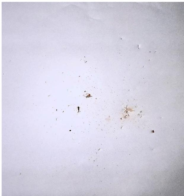
Resultado del *spalling* plasmado en la pantalla de papel. [Figura 67]. Fuente: Elaboración propia.
