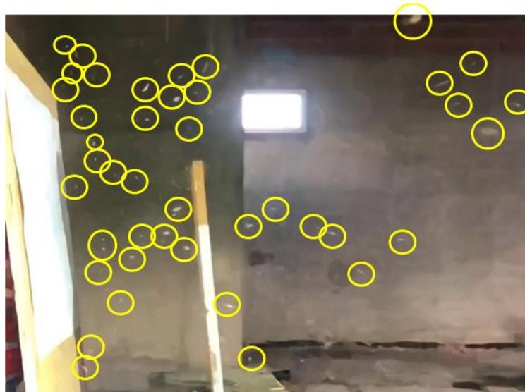
Fragmentos de madera dispersados por la ruptura del material ante el impacto por proyectil de arma de fuego calibre .45 ACP, generando el efecto *spalling*. [Figura 30]. Fuente: Elaboración propia.
