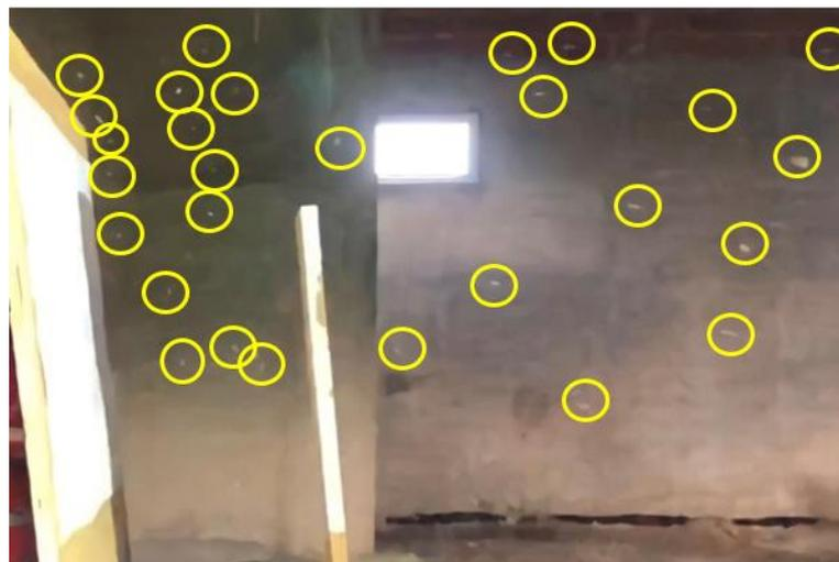
Fragmentos de madera aglomerada señalizados con círculos, dispersados por la ruptura del material ante el impacto por proyectil de arma de fuego, generando el efecto *spalling*. [Figura 28]. Fuente: Elaboración propia.
