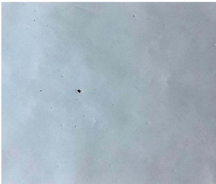
Resultado del efecto *spalling* representado en la pantalla de papel. [Figura 103]. Fuente:
