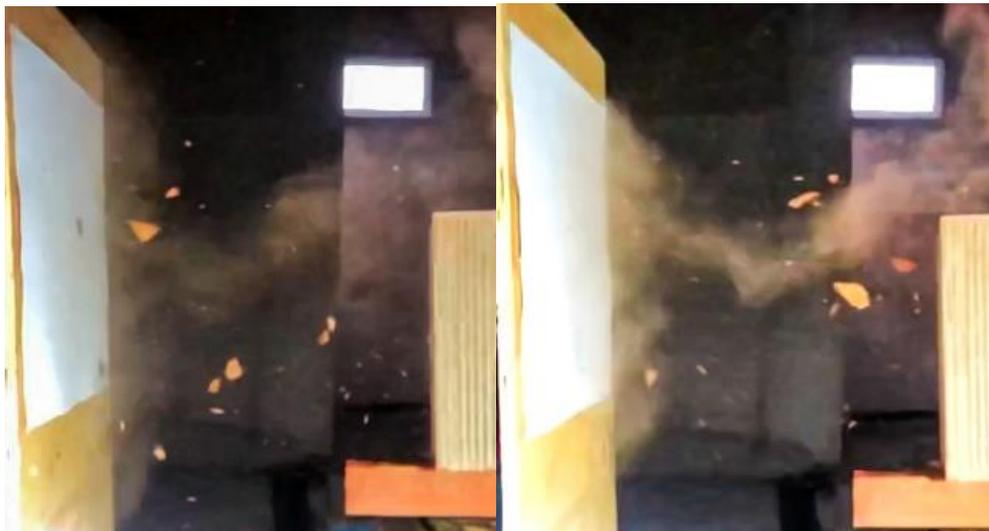
*Spalling* de ladrillo producido por el impacto por proyectil de arma de fuego calibre .22 LR.
