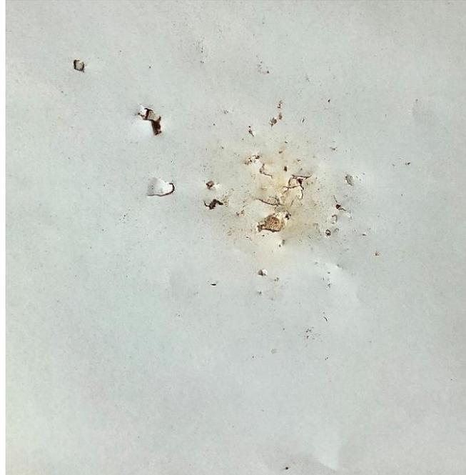
Efecto *spalling* en la pantalla de papel. [Figura 35]. Fuente: Elaboración propia.
