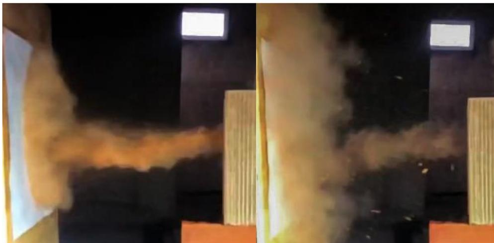
*Spalling* en forma de nube de polvo rojizo tras el impacto por proyectil de arma de fuego calibre .45 ACP. [Figuras 68 y 69]. Fuente: Elaboración propia.
