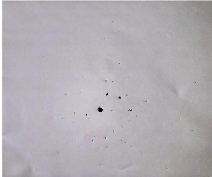
Efecto *spalling* en la pantalla de papel. [Figura 105]. Fuente: Elaboración propia.
