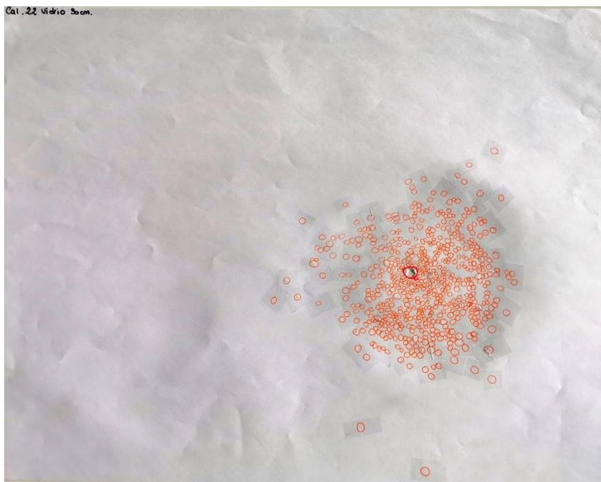
Resultado obtenido por el impacto por proyectil de arma de fuego calibre .22 LR. [Figura 124]. Fuente: Elaboración propia.
