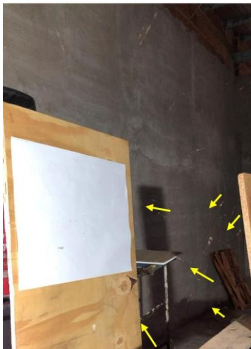
Otra imagen obtenida de un distinto ángulo fotográfico donde se aprecia la proyección de las astillas de madera aglomerada tras el impacto por proyectil de arma de fuego calibre .22 LR.
