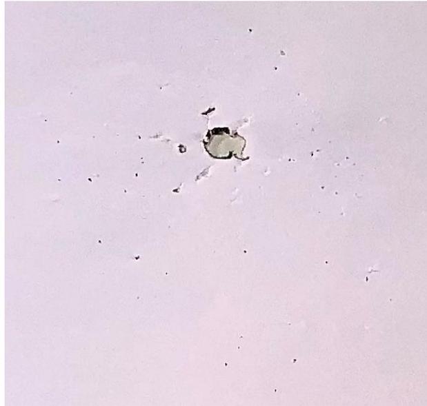
Resultado del efecto *spalling* producido por vidrio, a una distancia de 30 cm entre éste material y el blanco, con un disparo de arma de fuego calibre .45 ACP. [Figura 50]. Fuente: Elaboración propia.
