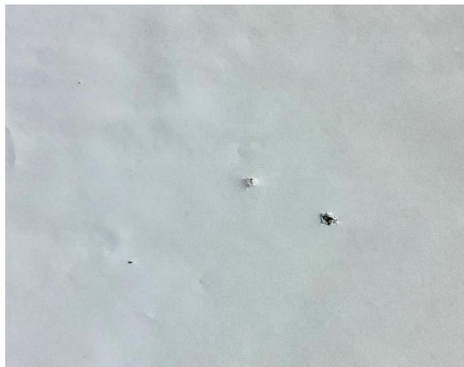
Efecto *spalling* en la pantalla de papel. [Figura 89]. Fuente: Elaboración propia.
