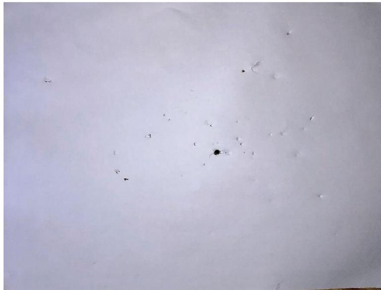
*Spalling* plasmado en la pantalla de papel, producido por un impacto de proyectil por arma de fuego calibre .45 ACP en un telón interpuesto correspondiente a una madera aglomerada con una distancia entre ésta con el blanco de 60 cm. [Figura 62]. Fuente: Elaboración propia.
