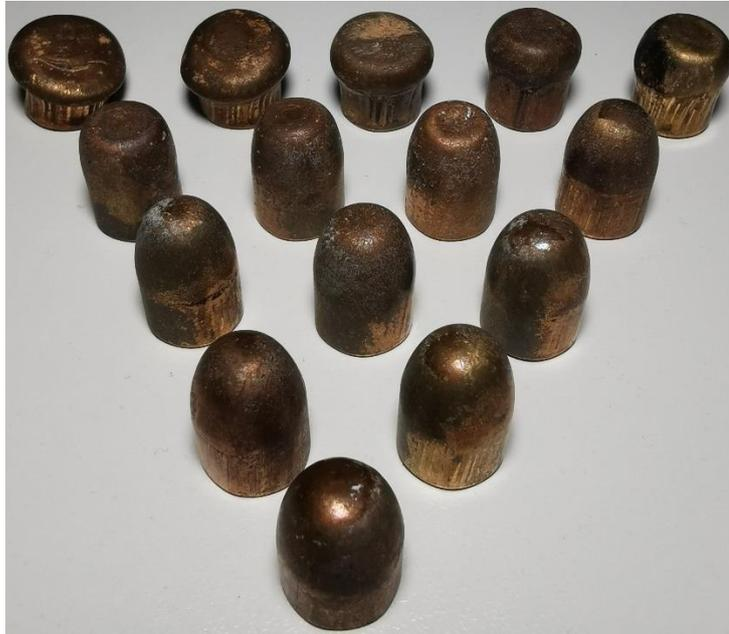
Proyectiles recuperados de los disparos producidos con la pistola calibre .45 ACP, donde se puede observar que no se presenta la fragmentación del blindaje del latón con el núcleo de plomo. [Figura 22]. Fuente: Elaboración propia.
