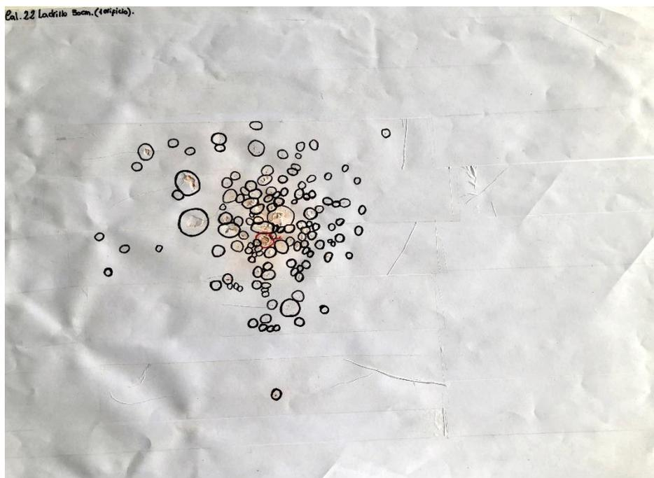
Resultado obtenido por el impacto por proyectil de arma de fuego calibre .22 LR. [Figura 118]. Fuente: Elaboración propia.
