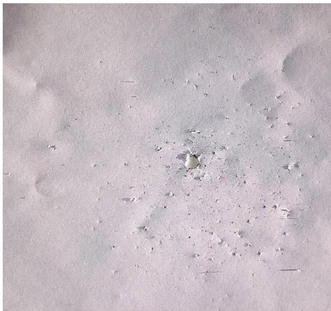
Resultado del efecto *spalling* producido por vidrio, a una distancia de 30 cm entre éste material y el blanco, con un disparo de arma de fuego calibre. 22 LR. [Figura 47]. Fuente: Elaboración propia.
