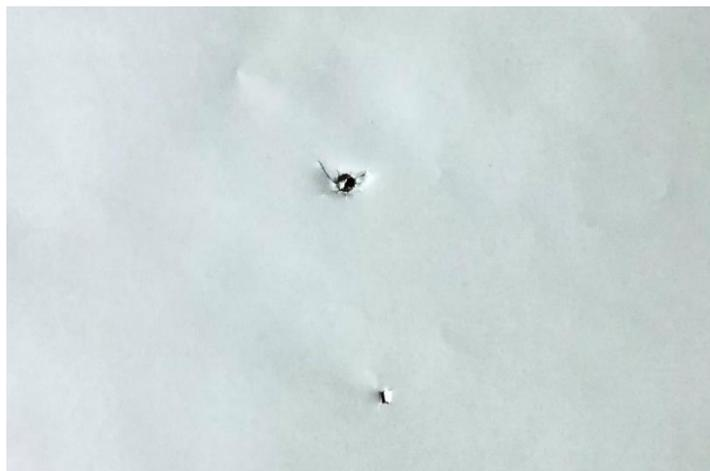
Resultado del efecto *spalling* en la pantalla de papel. [Figura 87]. Fuente: Elaboración propia.
