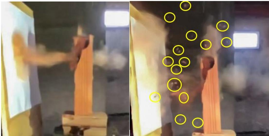
Otra imagen obtenida de un distinto ángulo fotográfico del fenómeno de espalación en el ladrillo hueco con una pistola calibre .22 LR. [Figuras 33 y 34]. Fuente: Elaboración propia.
