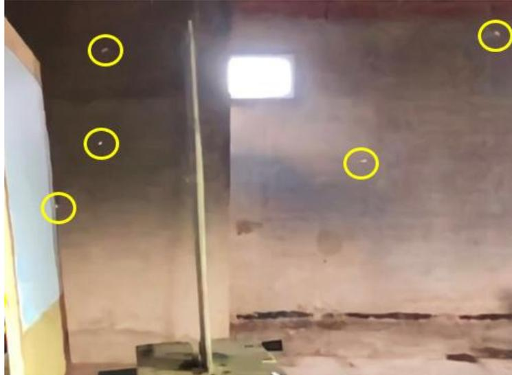
Fragmentos de madera dispersados por la ruptura del material ante el impacto por proyectil de arma de fuego calibre .45 ACP, generando el efecto *spalling*. [Figura 26]. Fuente: Elaboración propia.
