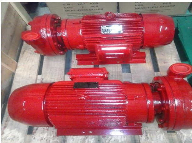
Bomba WDM No Normalizada Salida lateral – Modelo anterior obsoleto.
