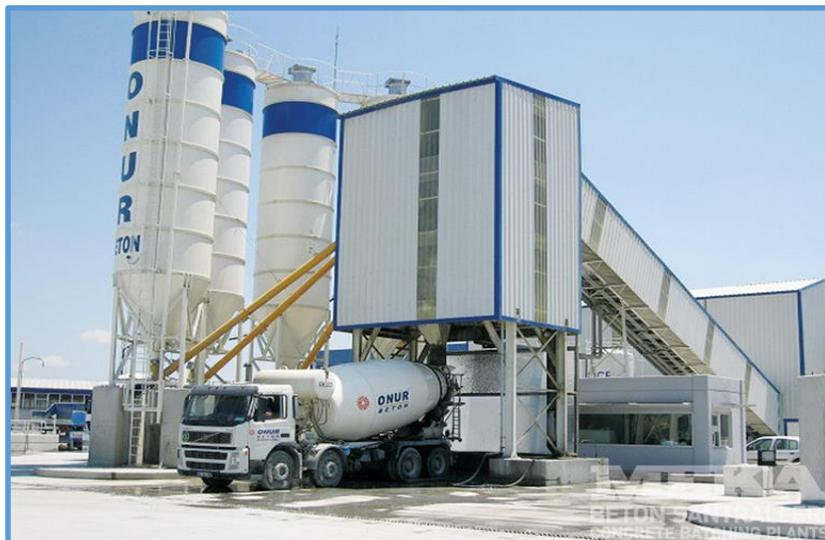
La preparación del hormigón elaborado en planta central prácticamente elimina las posibilidades de malos resultados que pueden derivar de las operaciones relativas a dicha preparación.
