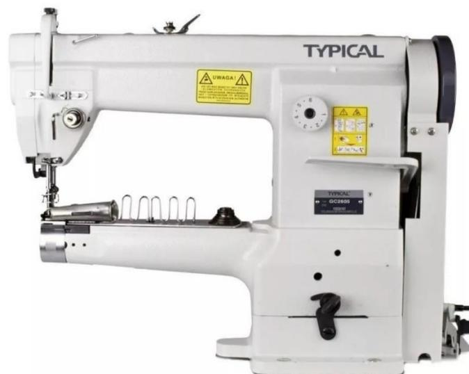
Máquina de coser con triple arrastre, diseñada para trabajar con materiales pesados con rapidez y eficiencia.
