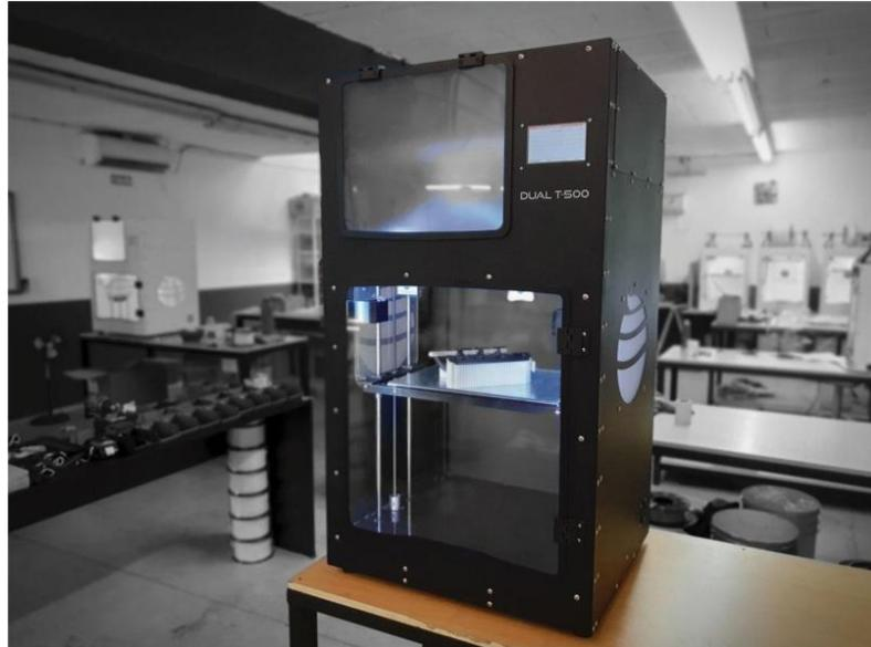
La TRIDEO DUAL T impresora 3D con 2 cabezales capaz de fabricar dos elementos al mismo tiempo o trabajar sobre uno solo a mayor velocidad. Fundamental para acelerar el proceso productivo.
