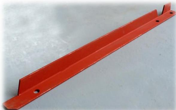
**Frenos:** Son fabricados en acero al carbono a partir de un perfil standard L. Estos elementos son los que unen los arcos de soporte entre si otorgándole rigidez estructural al sistema de sostenimiento. Existen dos tipos de frenos –derecho e izquierdo- dependiendo de qué lado de la estructura del arco vayan a colocarse los mismos.
