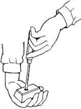
Ilustración 56: Sujeción incorrecta de una pieza a atornillar
