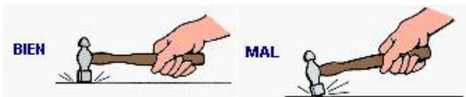
Ilustración 66: Forma de golpear sobre una superficie
