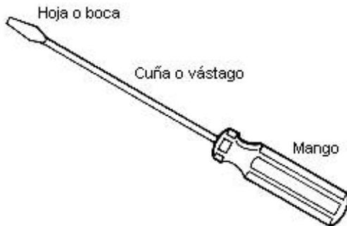
Ilustración 54: Partes de un destornillador
