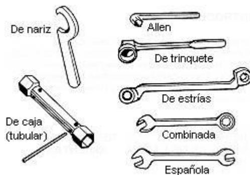
Ilustración 69: Tipos de llaves de boca fija
