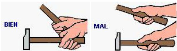
Ilustración 65: Forma de sujeción del mango
