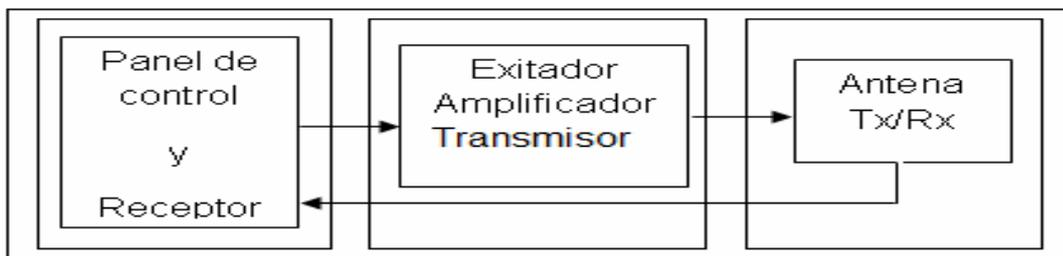
Figura N° 12: DIAGRAMA EN BLOQUE DE UN EQUIPO DE VHF
