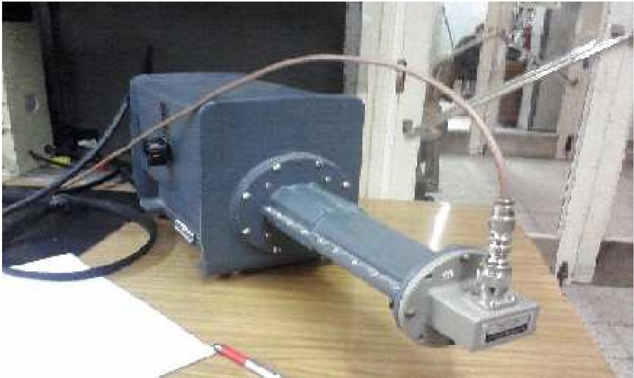
Foto N° 18: ADAPTADOR DE ANTENA
