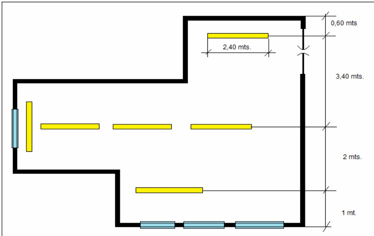
Figura N° 4: DISTRIBUCION DE ILUMINACION EN LA SECCION DE COMUNICACIONES
