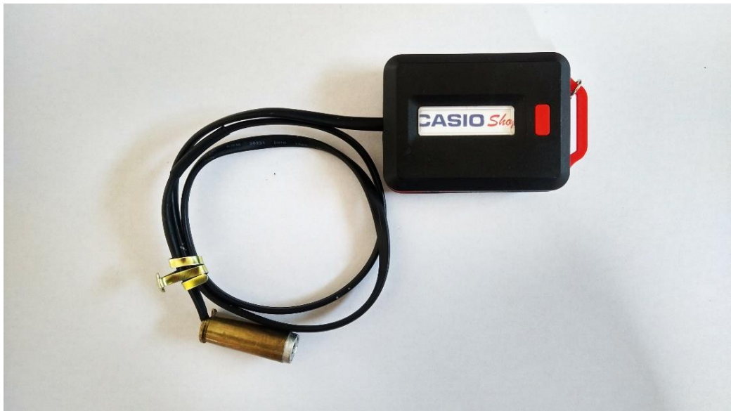
Colimador hecho con un cartucho del arma utilizada. Fuente: elaboración propia.
