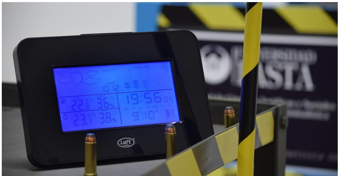
Instrumental para medir temperatura, presión atmosférica y humedad al momento del disparo.
