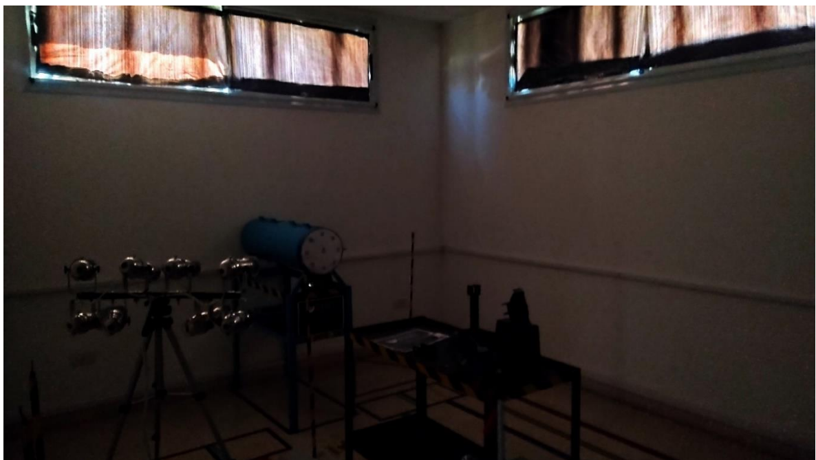
Ventanas tapadas con cartulinas negras y polietileno negro virgen para oscurecer el espacio
