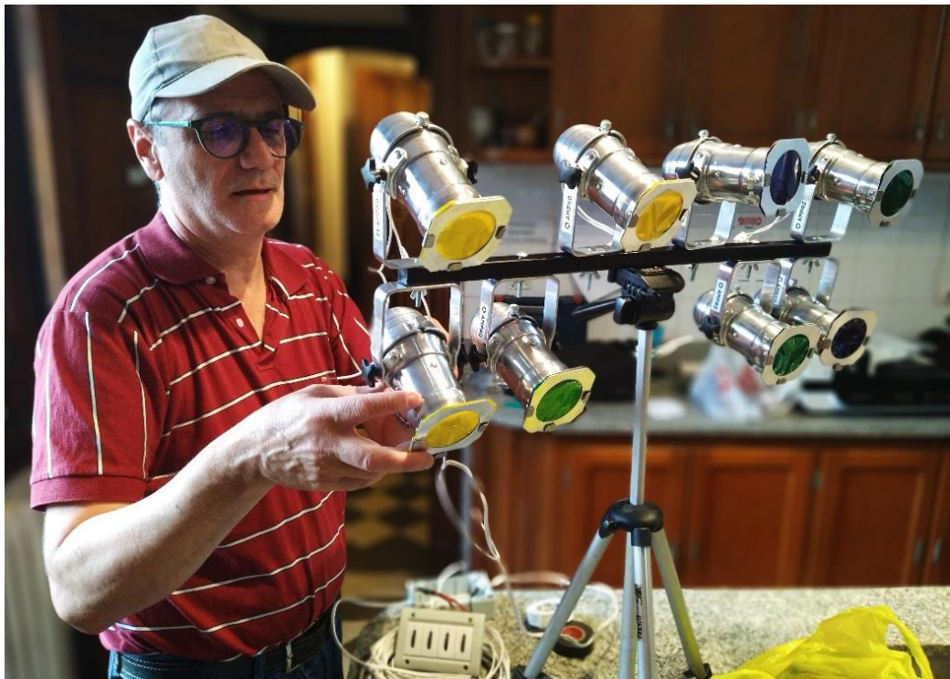
Armado de set de luces con reflectores par 16. Fuente: elaboración propia
