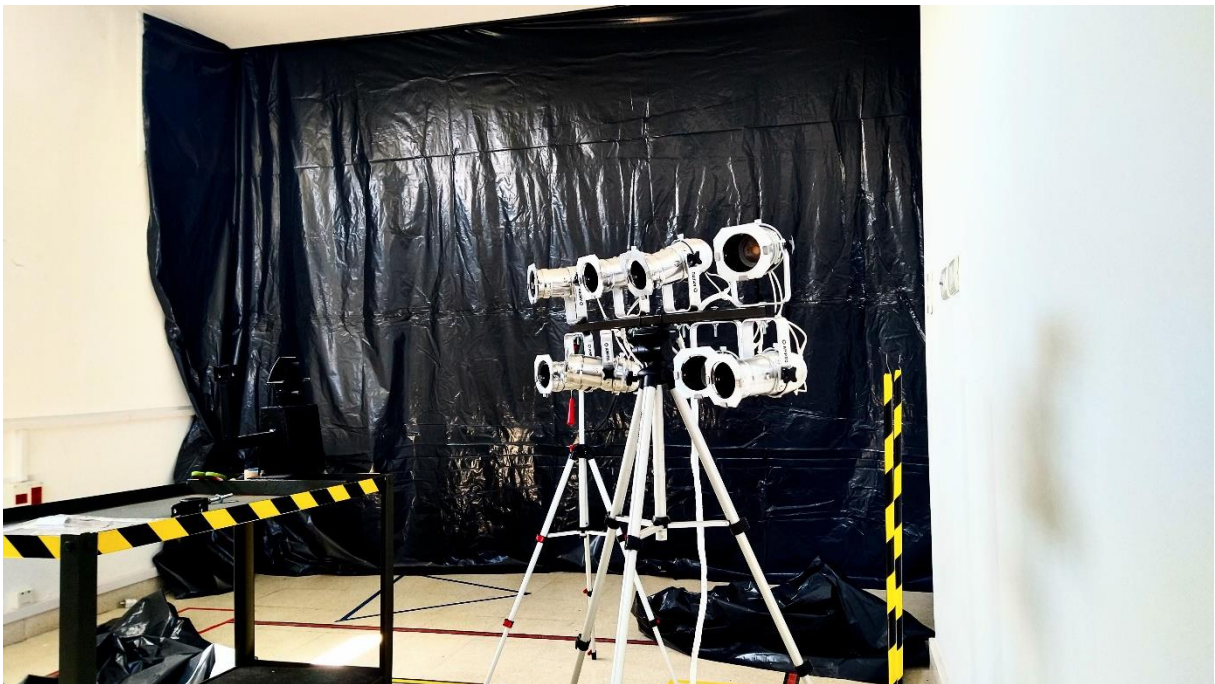
Cerramiento con polietileno virgen de 200 micrones. Fuente: elaboración propia.
