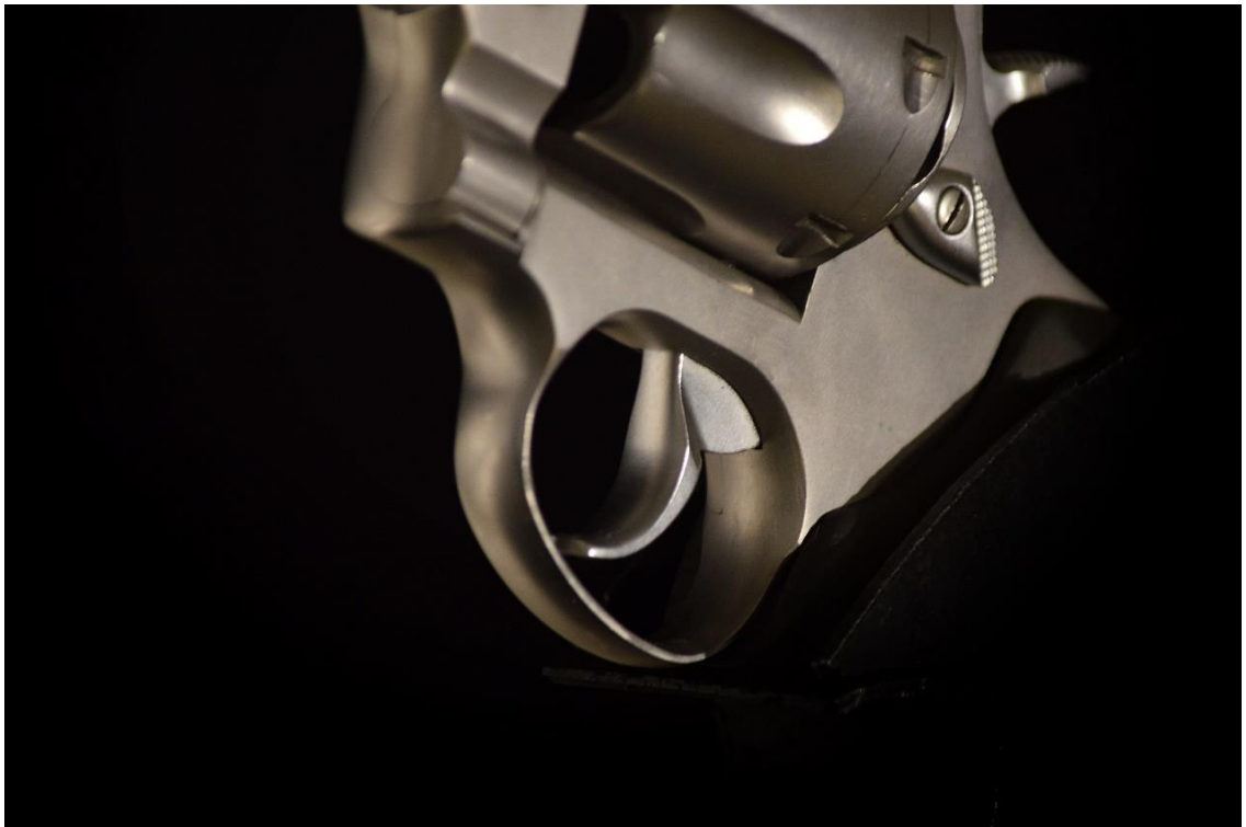
Cola del disparador protegida por el arco guardamonte. Fuente: elaboración propia.
