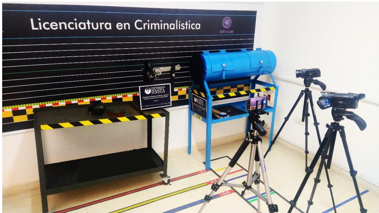
Cámaras de video ubicadas para captar la nube de gases. Fuente: elaboración propia
