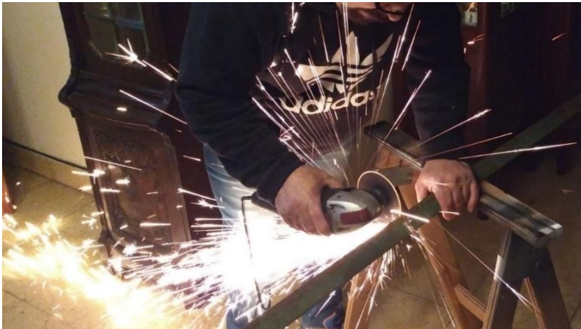
Corte de hierro reciclado que formara la estructura del Banco de Puntería Fija (BPF)
