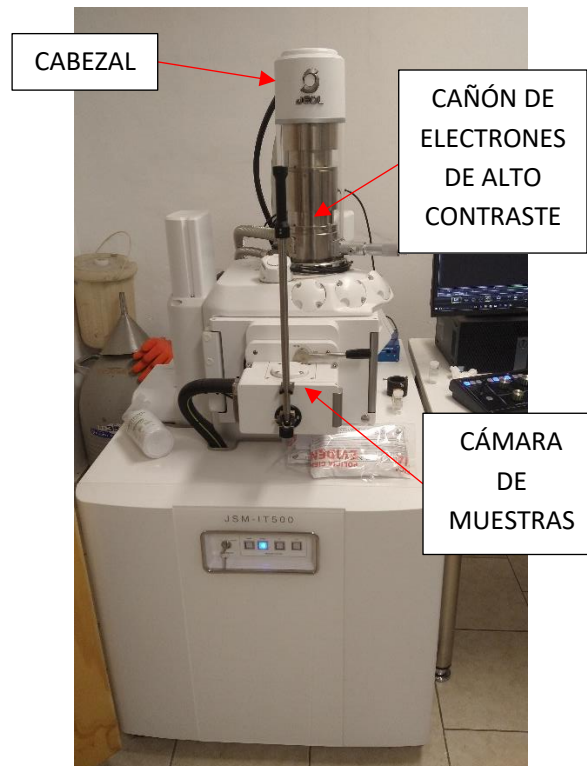
Cuerpo principal del MEB donde se observan sus diferentes partes.
