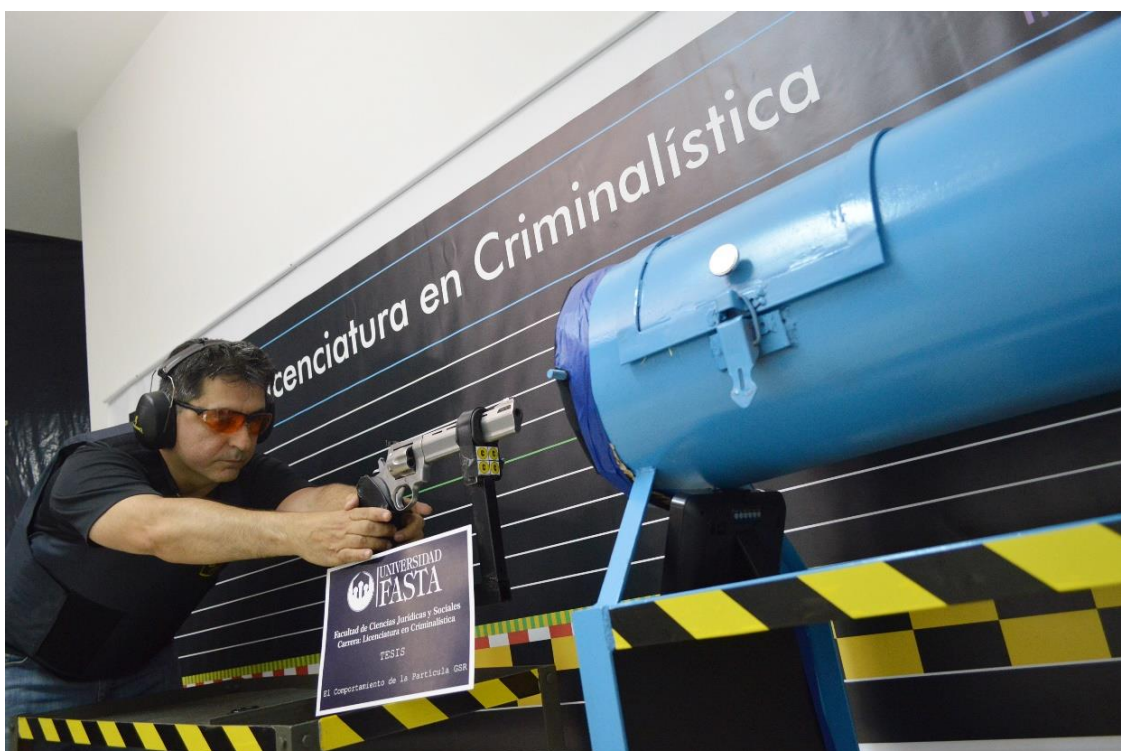
La posición de disparo obedece a que, por la corta distancia entre la boca del cañón y el telón interpuesto, se tuvo que dar vuelta la zapata para que quede el arma en posición y a distancia, quedando la parte más larga del BPF, entre el tirador y el arma.
