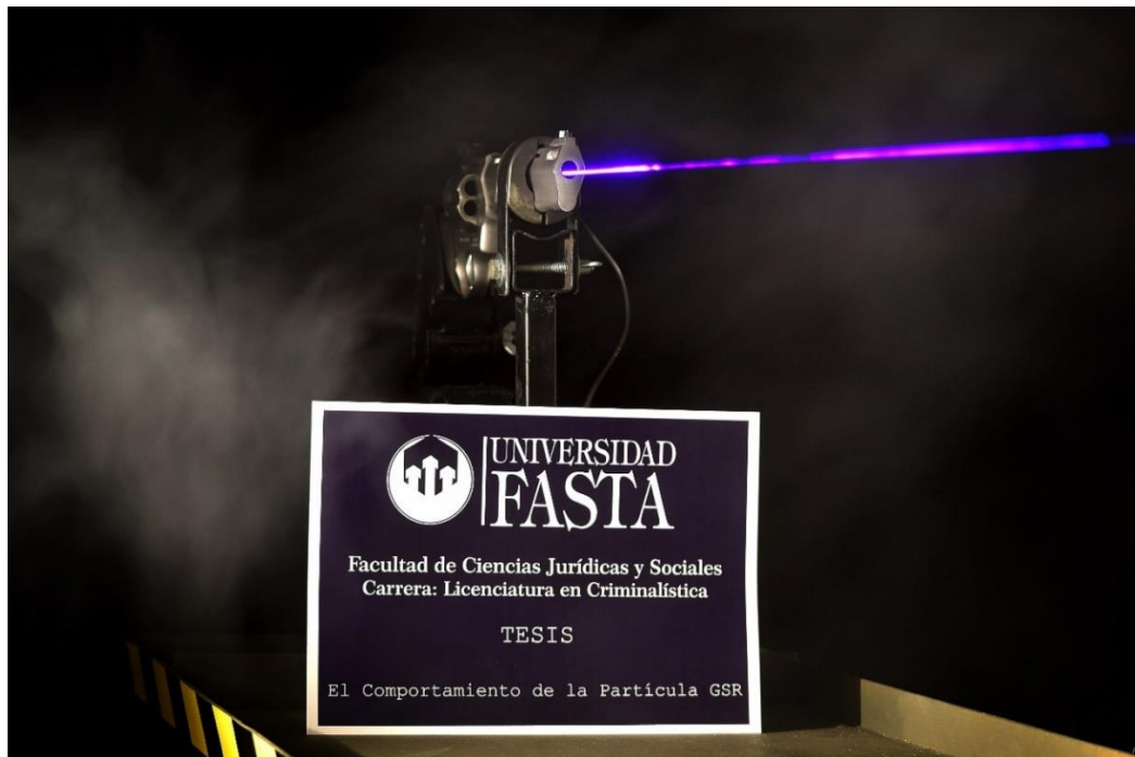
Colimador dentro de la recámara o alveolo proyectando la trayectoria del proyectil. Fuente: elaboración propia.
