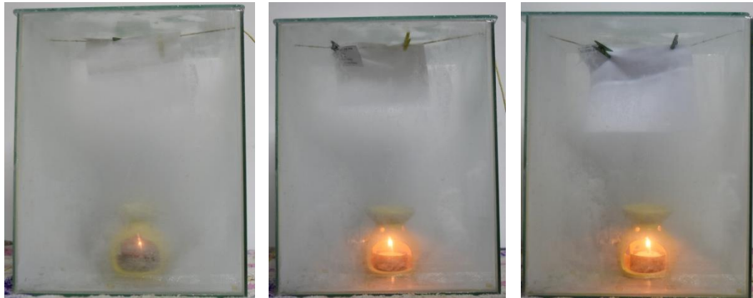
Distintas muestras expuestas a los vapores del cianoacrilato
