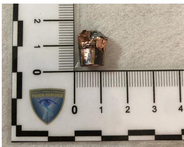
Ilustración N°6. Munición Hornady Critical Defense 9 mm. Fuente: Elaboración propia
