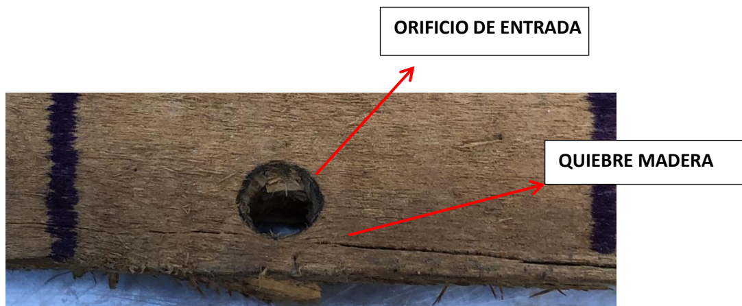
Ilustración N°15. Impacto en telón interpuesto, madera. Fuente: Elaboración propia
