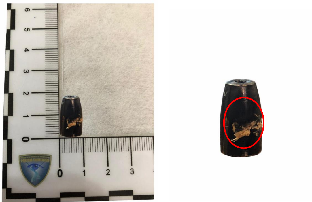
Ilustración N° 8 y 9. Munición Winchester Black Talon 9 mm. Fuente: Elaboración propia
