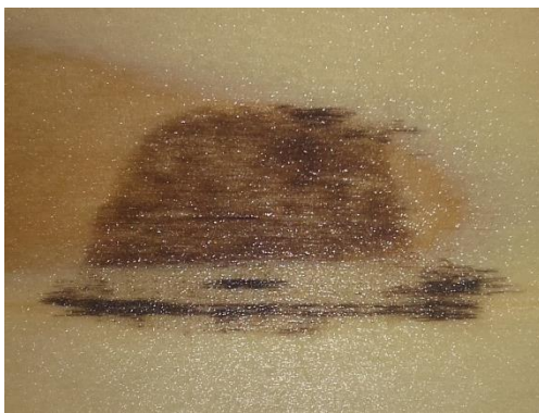
Lavado madera con agua fría
