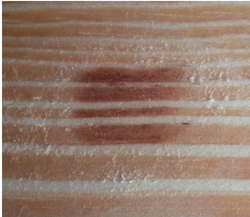
Lavado madera con agua fría
