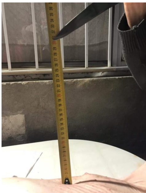
Figura 32: Cuchilla ubicada a 30 centímetros de la superficie abdominal con un ángulo de 45°. Elaboración propia.
