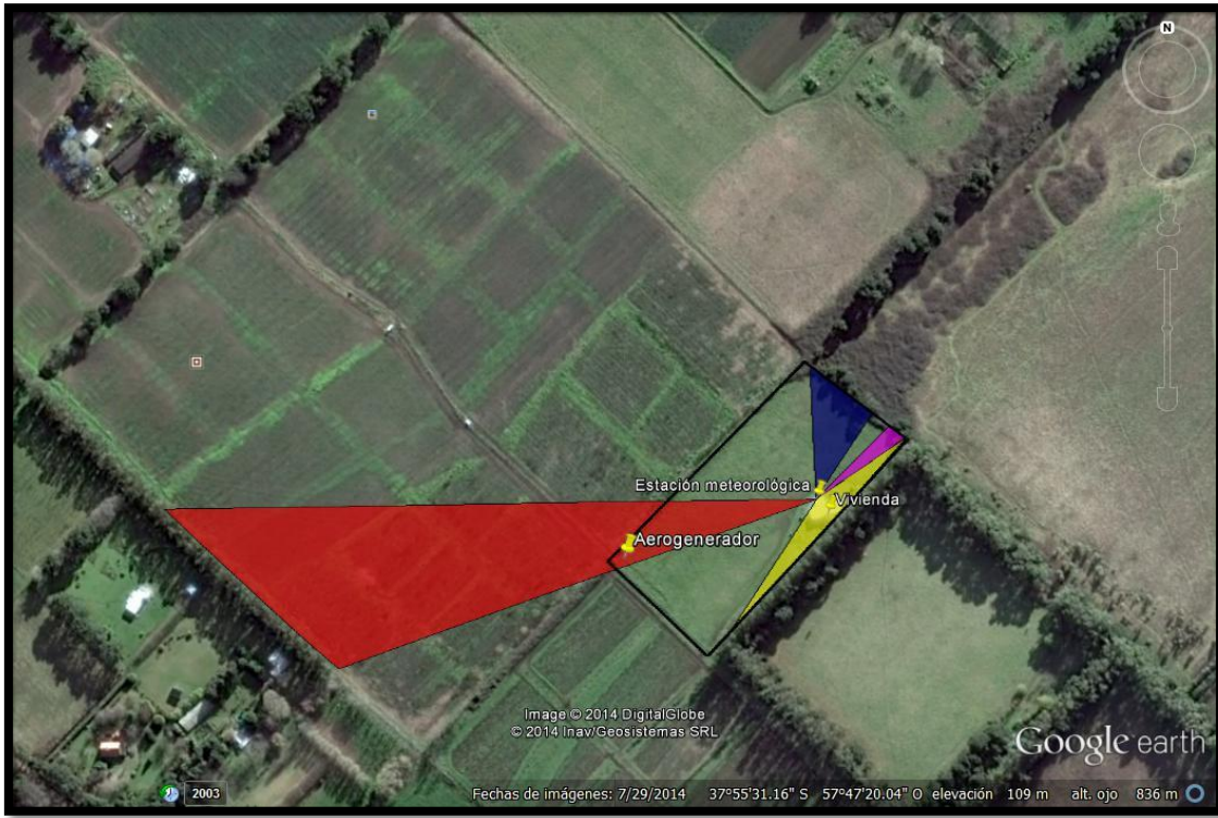
Figura 24. Cinturón de interferencias. Elaboración propia utilizando Google Earth®
