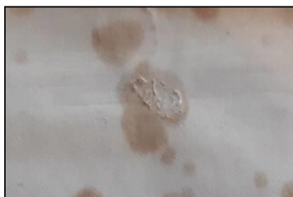
Figura 73: Micelio – Muestra N° 49. Puede presentarse en forma de estratos u hongos microfilamentosos, también conocidos como mohos. Fuente: Elaboración propia.
