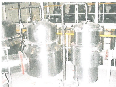
Evaporador usado de 3 efectos AZ Ingeniería
