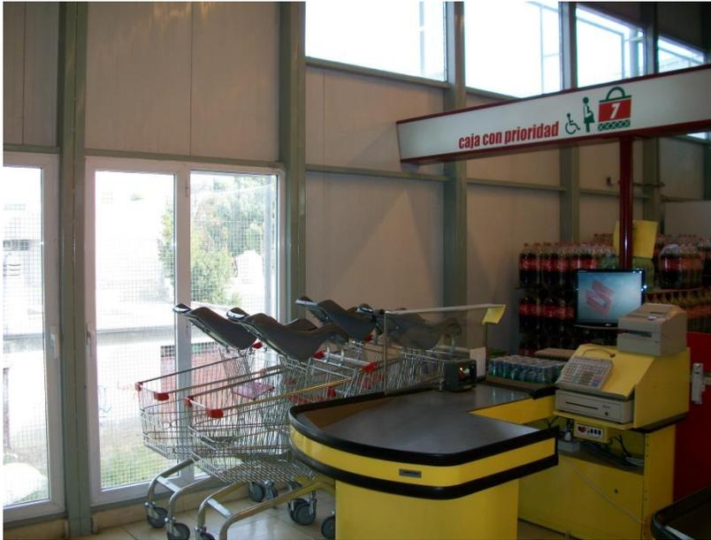
Foto tomada desde la parte trasera en donde las operías de cobro realizan sus tareas; se puede apreciar que la iluminación ingresa por las ventanas y puertas cercanas, evitando cansancio en la vista de las mismas al encender menos luminarias en el horario diurno. La construcción fue adoptada a fin de eliminar el deslumbramiento directo reflejado en las pantallas.
