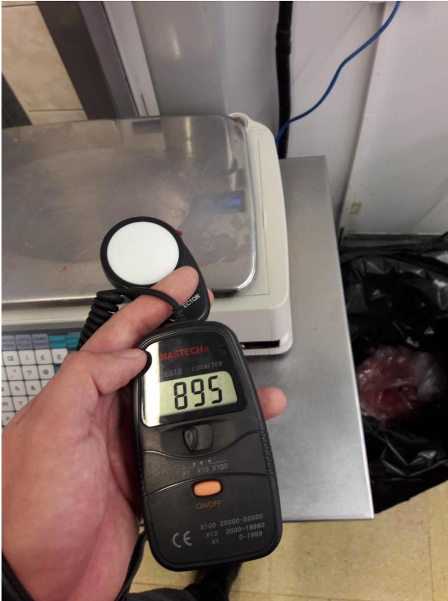
El luxómetro (también llamado luxmetro o light meter) es un instrumento de medición que permite medir simple y rápidamente la iluminancia real y no subjetiva de un ambiente. La unidad de medida es el lux (lx). Contiene una célula fotoeléctrica que capta la luz y la convierte en impulsos eléctricos, los cuales son interpretados y representada en un display o aguja con la correspondiente escala de luxes.
