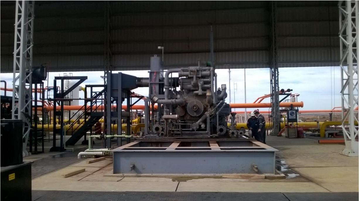
FIG31- Motocompresor desmontado para ser trasladado.
