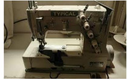
1. Instalar la aguja simple en la máquina y ajustar la tensión según el peso del género que utilice.
