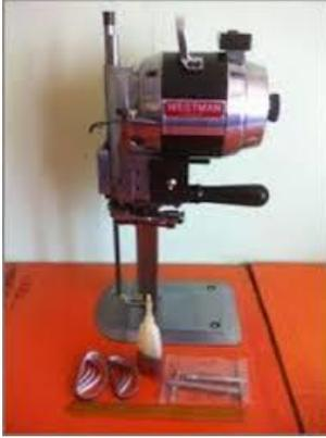
Esta máquina realiza la operación de corte de la tela, esta operación es decisiva, una vez realizada es prácticamente imposible corregir errores graves. Consta de un disco interno de 4 a 20cm de diámetro que al girar una cuchilla recta realiza el corte, con esta máquina se pueden cortar pliegos de tela con anchuras de hasta el 40% del diámetro del disco, usada correctamente es versátil esta máquina permite cortes de gran exactitud por lo delgado de la banda.
